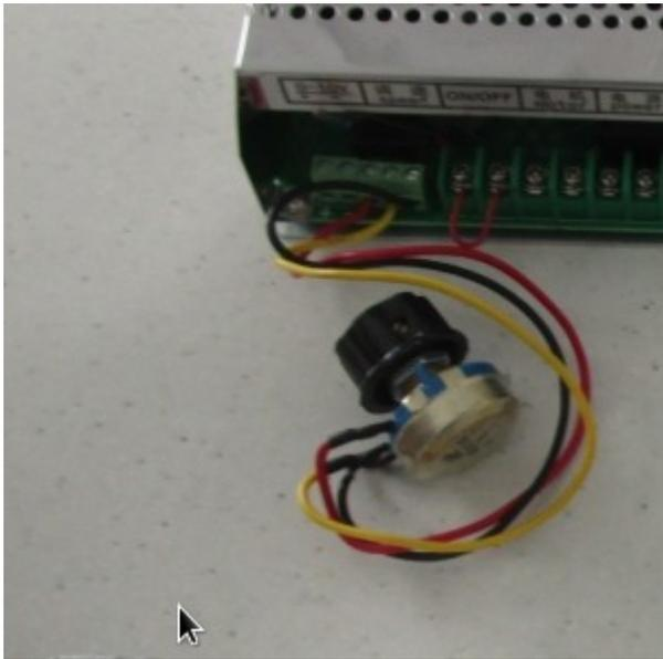
Voilà, vous pouvez connecter le 220V de la broche et tester la rotation du moteur en faisant varier le potentiomètre.
