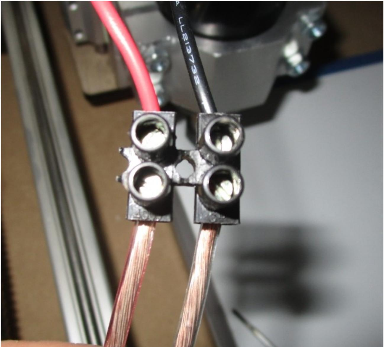
Connecter la rallonge de broche sur l'alimentation (Attention : 110V!) sur le bornier « motor » et câbler le câble 220V sur le bornier « power » :
