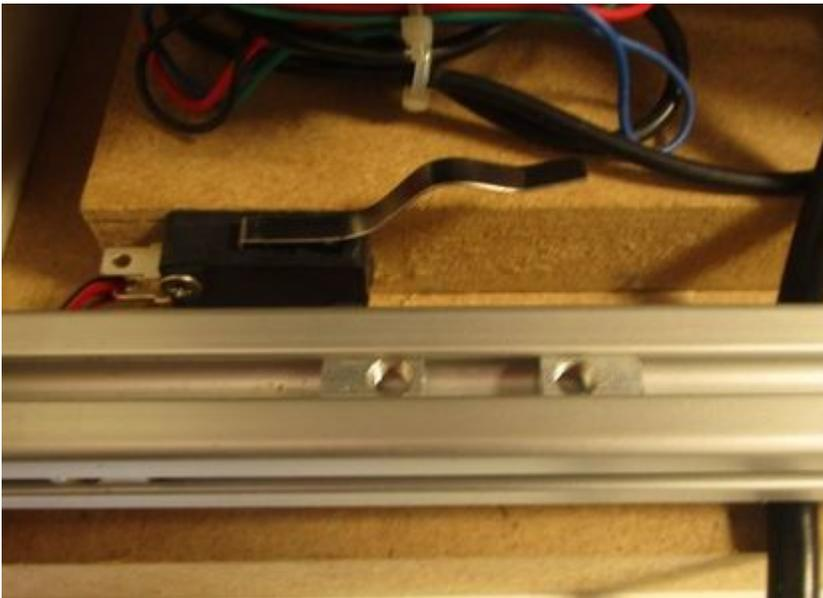
Et fixer la plaque de déclenchement : il est impératif que la plaque déclenche le endstop. Si ce n'est pas le cas, déformer vers le haut la languette du endstop de manière à assurer franchement le contact.
