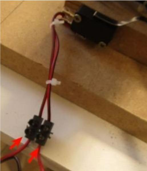
A présent, connecter le bloc d'alimentation sur 220V et le Jack sur le bloc de contrôle du laser : appuyer sur le endstop ce qui doit déclencher le ventilateur. Relâcher dès que c'est vérifié.
