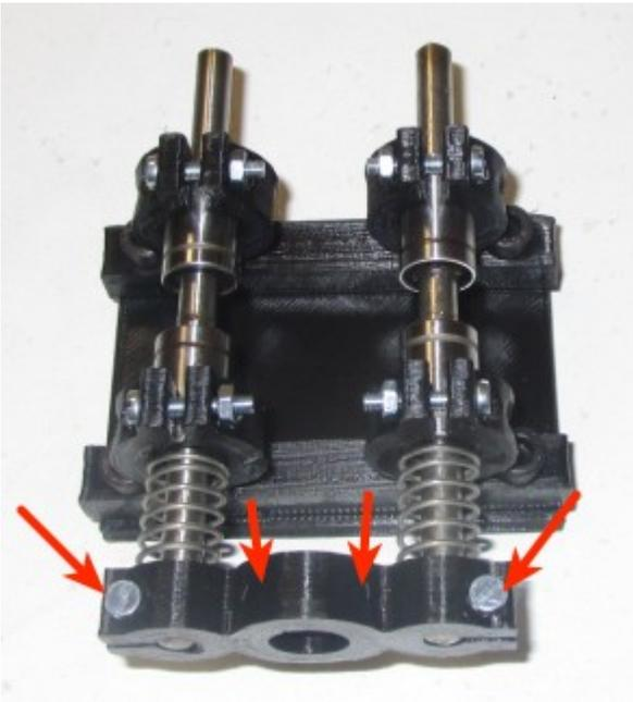
Engager ensuite l'autre pièce 3D d'extrémité au ras des barres lisses de l'autre côté (là encore veiller à ce que les trous des vis de serrage du crayon soient vers l'avant ++ ): s'aider au besoin d'un marteau pour l'engagement en tapant modérément dans l'axe de chaque barre lisse. Serrer à l'aide des vis M3 x 16 + écrou
