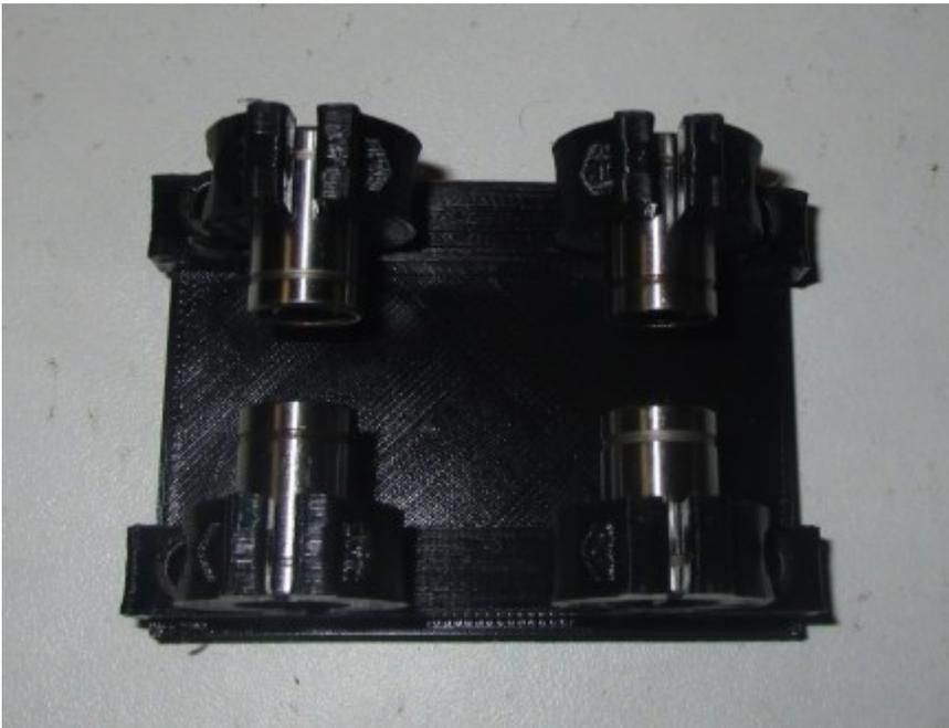
Engager chacune des barres lisses 6mm en réalisant une rotation lors de l'engagement :
