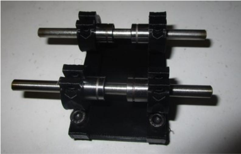
Mettre en place les vis M3x16 + écrou de serrage... mais sans serrer pour ne pas contraindre les vis à billes inutilement :
