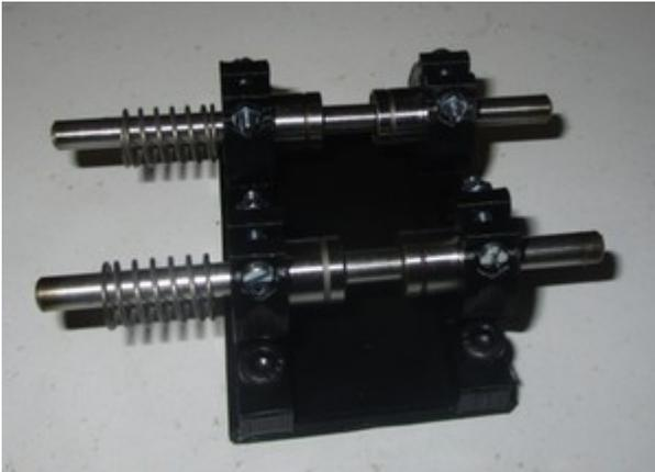
Engager la pièce 3D d'extrémité au ras des barres lisses et serrer à l'aide des vis M3 x 16 + écrou (veiller à ce que les trous des vis de serrage du crayon soient vers l'avant ++ ) :
