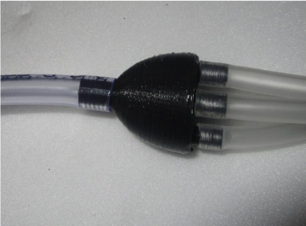
Connecter l'autre extrémité du gros tube sur l'entrée du dispositif de pulvérisation (faire réaliser un trajet au gros tube le long de la broche / aspiration de façon à ce qu'il ne gêne pas les mouvements de la machine ensuite)
