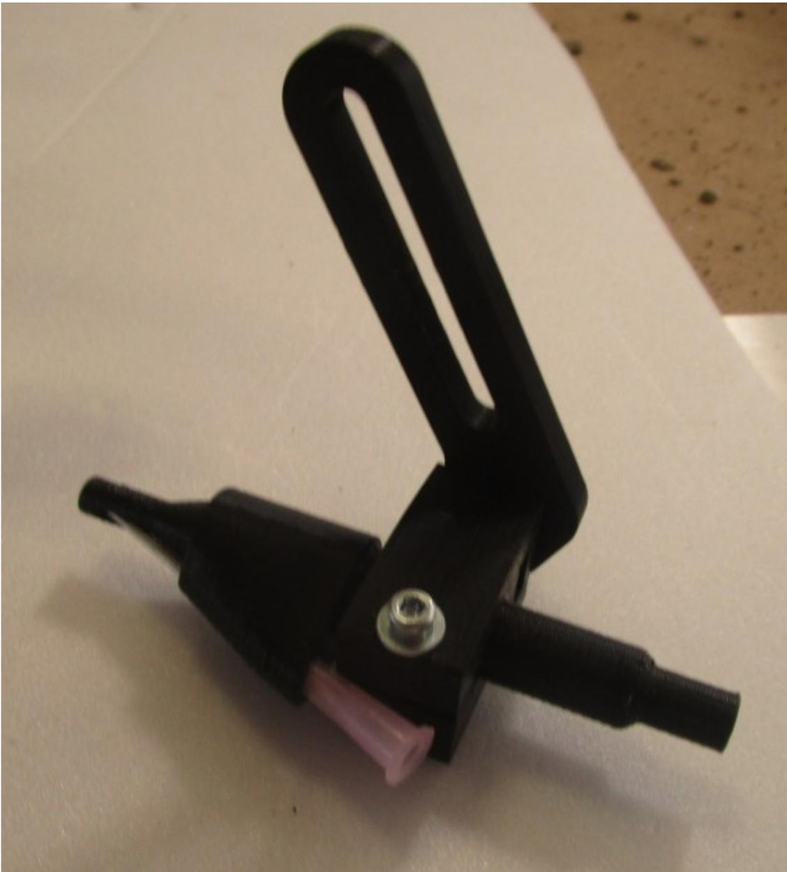
Fixer l'ensemble sur la petite équerre fixée précédemment, à l'aide d'une vis M5x16 THC + écrou + rondelle :
