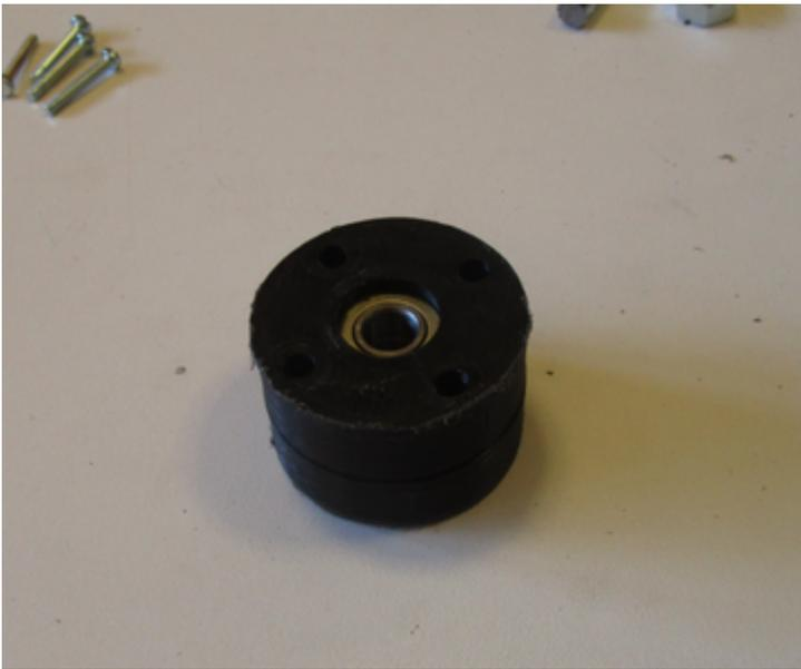
Solidariser l'ensemble à l'aide des 4 vis M4 x 30 + rondelles+écrous M4
