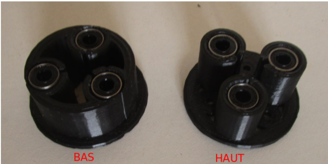
Fixer les 2 parties fixes haute et basse ensemble à l'aide des 3 vis M3x16 :
