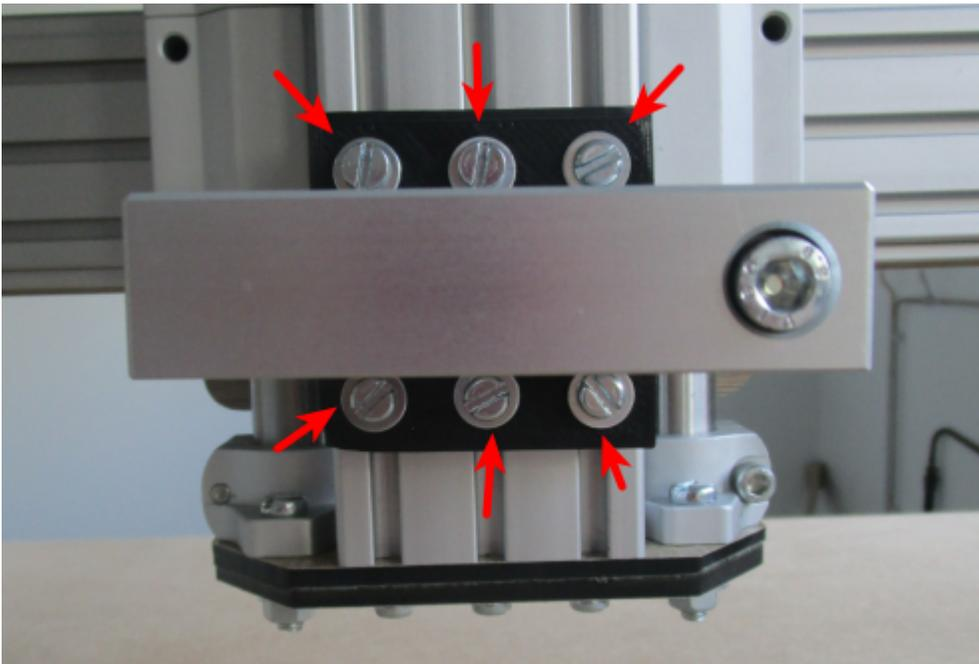
Truc : s'aider d'une clé allen pour positionner les écrous lourds dans le profilé de façon à les placer face aux trous des vis.
