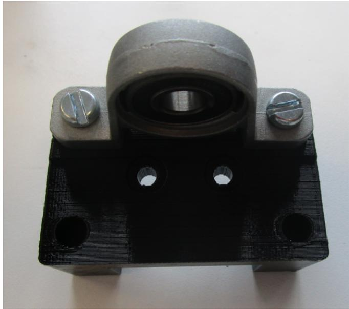
Le mettre en place « à cheval » sur le profilé et le fixer à l'aide des vis latérales :
