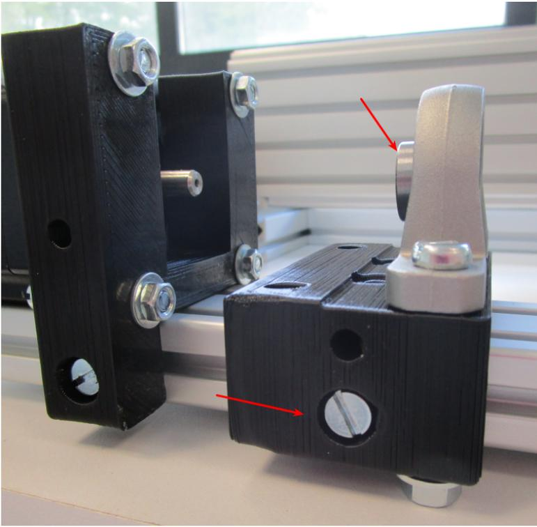
Fixer le support d'écrou de vis à billes sur l'écrou de la vis à billes à l'aide de 4 vis M5 x 45mm. **Attention : il y a un sens et un support différent pour le côté droit et le côté gauche.** La surface métallique de l'écrou est côté moteur et l'écartement le plus réduit entre les gros trous et le bloc d'écrou se place vers le haut.
