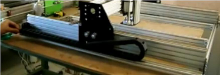
Fixer la chaîne au chariot à l'aide d'un plat 20x80 fixé sur une équerre :
