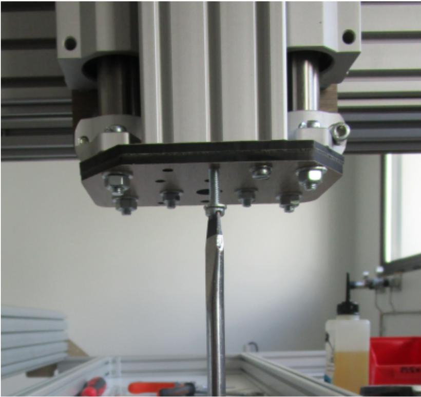
Une fois fait, remettre en place les vis de serrage du roulement du haut et resserrer toutes les vis de serrages des supports d'extrémités.
