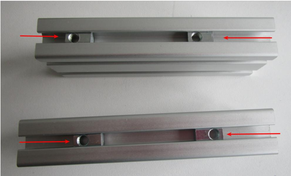
Ensuite, mettre en vis à vis les 2 plaques du chariot et mettre en place le profilé 20x40x110mm du haut (que l'on a préalablement taraudé en M5x0.8 ) et fixer avec des vis M5 x 20mm :
