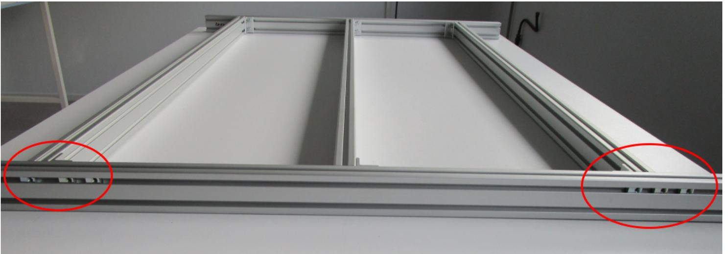
Ensuite, positionner les 2 rails Y aux extrémités des profilés avant et arrière, les plaque de jonction venant se placer en regard des écrous et fixer les plaques à l'aide de vis **M5x12mm**.
