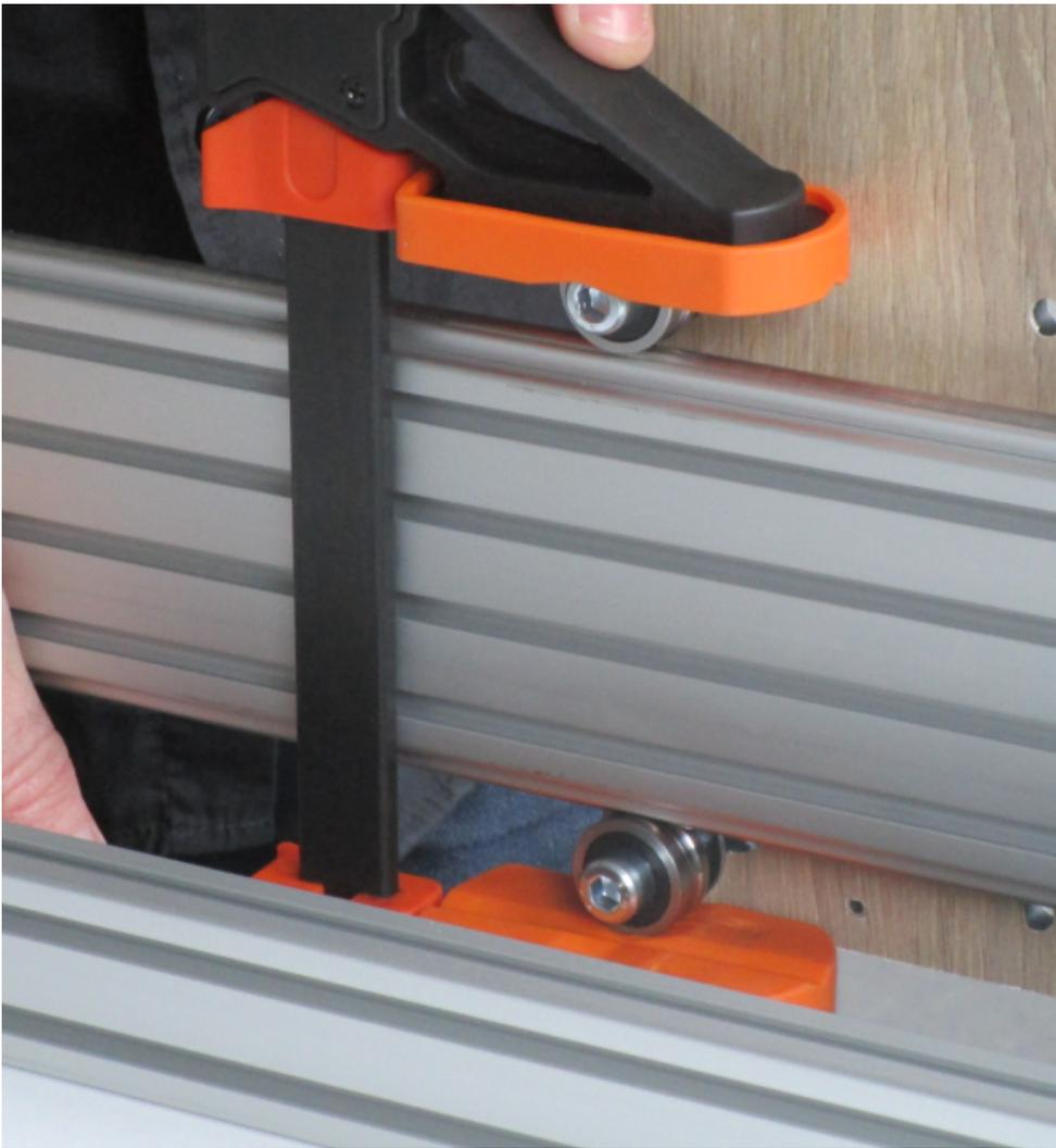
**Alternative : rapprocher les 2 vis du bas avec le serre-joint (mettre les mors du serre-joint en regard d'un plat des écrous)**
