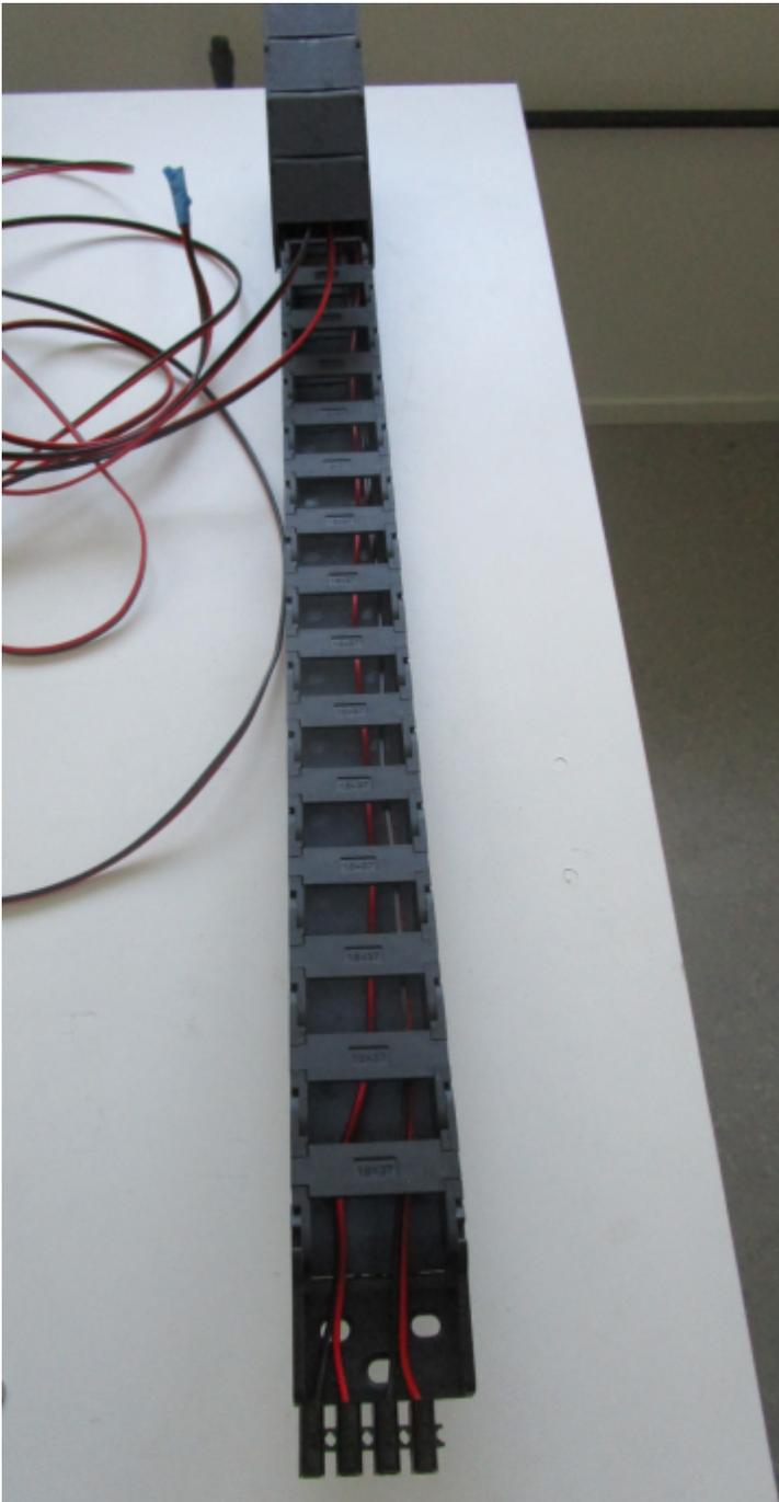
Truc : mettre un bout de scotch prenant les 2 câbles sur l'extrémité que l'on va enfiler dans la chaîne.
