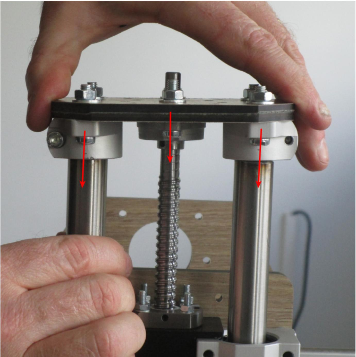
Truc : mettre un support rigide sous le plateau inférieur et taper au marteau si besoin
