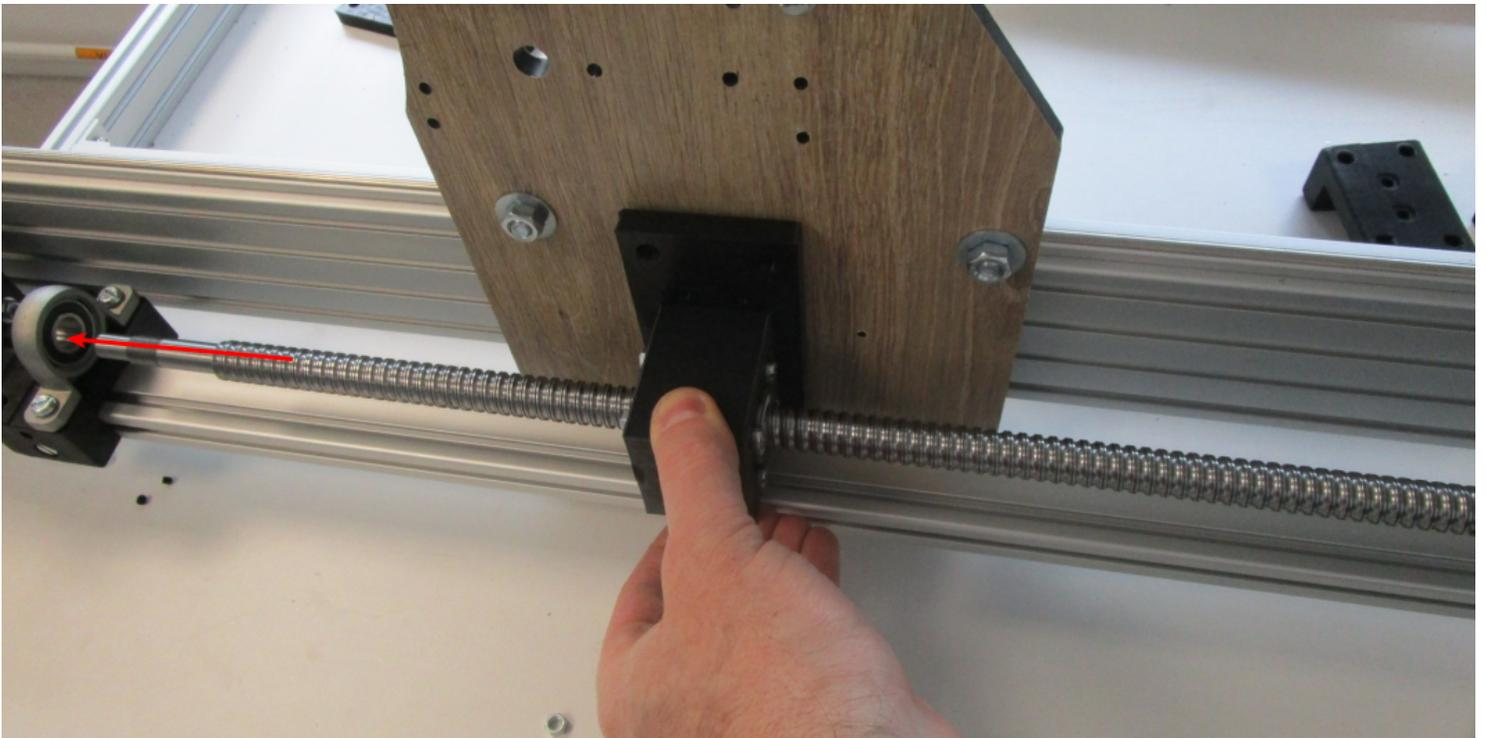
Puis engager la vis à billes dans le roulement côté moteur et le coupleur d'axe : ajuster les position, et serrer les vis latérales :
