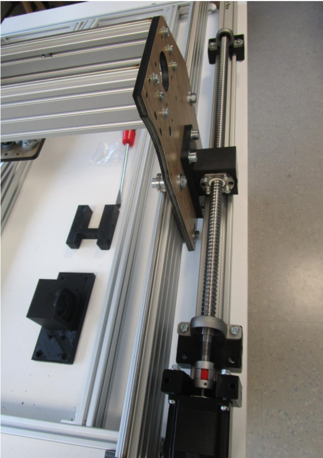
Reste à faire la même chose de l'autre côté en veillant à inverser le sens du support d'écrou de la vis à billes.
