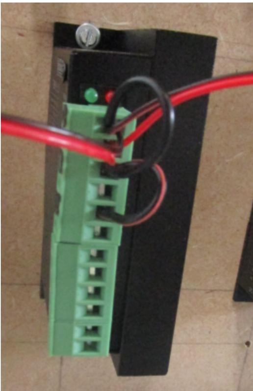
**POINT ESSENTIEL : NE PAS CONNECTER LA MASSE LOGIQUE SUR LA MASSE DE L'ALIMENTATION MOTEUR !** Les étages moteurs sont opto-couplés : il ne doit donc y avoir AUCUN point commun entre la partie logique et la partie puissance pour garder le bénéfice de la protection de l'optocouplage.
