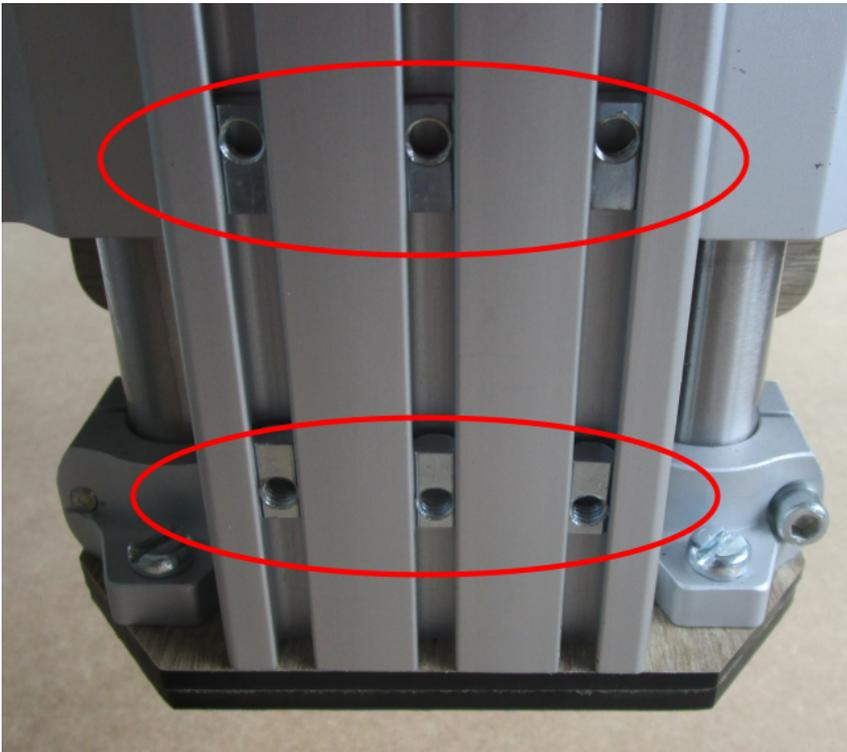
Mettre en place le rail alu de façade et fixer avec vis M5 x 20 :
