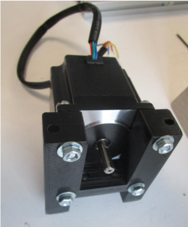
Ensuite, mettre l'ensemble à cheval sur le profilé de façon à ce que l'arrière du moteur soit aligné sur l'extrémité du profilé et le fixer latéralement à l'aide des vis M5x 16mm en utilisant les écrous lourds précédemment engagés.
