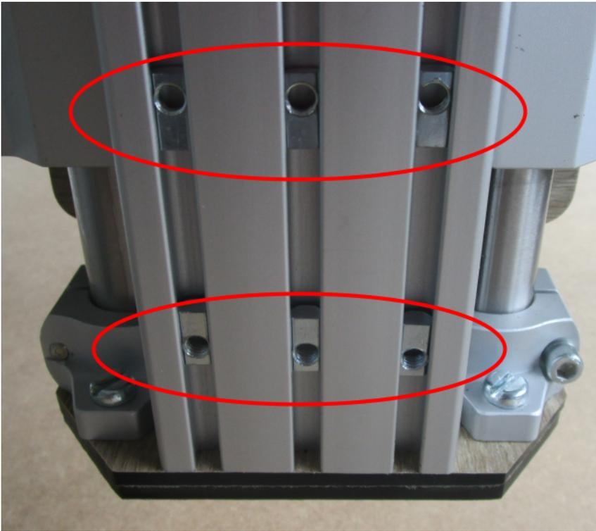
Fixer le support à l'aide des 6 vis **M5x20mm** + rondelles M5 moyenne, en veillant à positionner la tête de la vis de serrage du support de broche vers l'avant :
