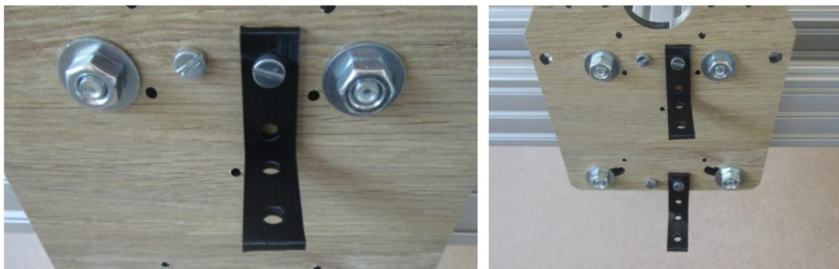
Fixer l'extrémité de la chaîne avec la barette de connexion (côté moteur) sur l'équerre du haut :
