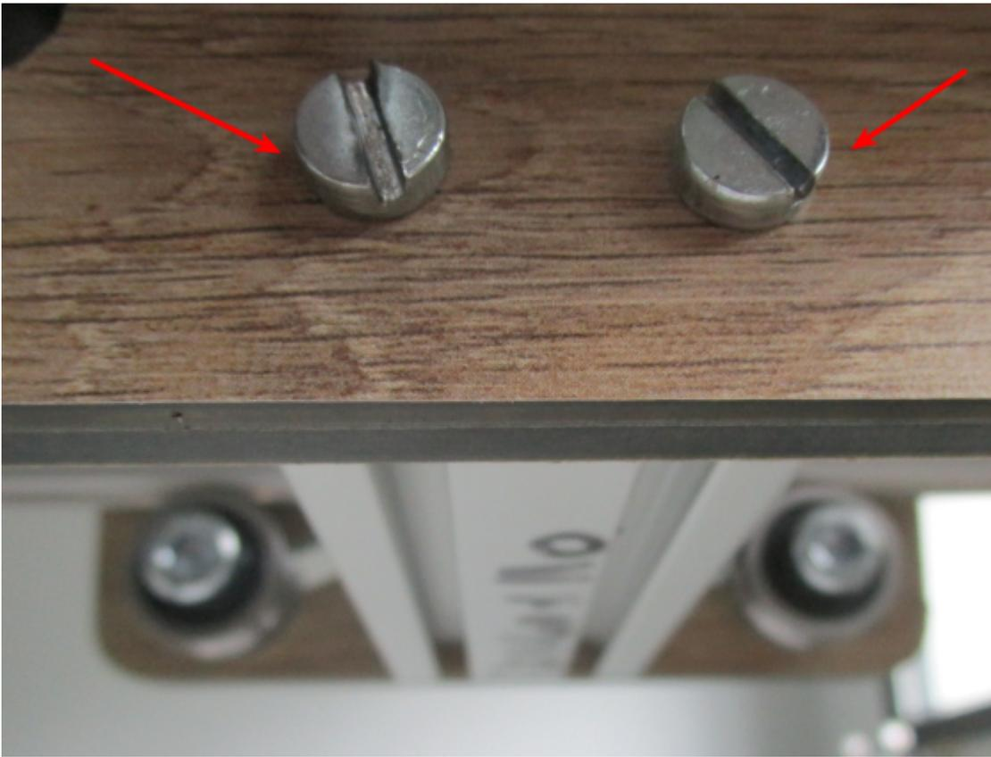
NOTE : Une fois le chariot en place, faire quelques aller-retours les vis d'extrémité du profilé arrière de l'axe X étant desserrées, puis une fois que la translation se fait bien, serrer à fond les vis d'extrémités du profilé arrière de l'axe X.
