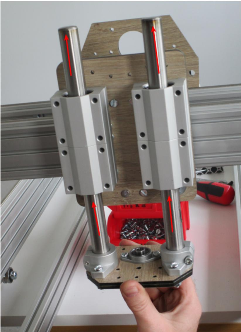
**NOTE : Une alternative consiste à engager les 2 barres par le haut et à engager les barres dans les supports d'extrémité une fois fait, la plaque inférieure du Z étant placée en dessous, sur une planche simulant le martyr..**
