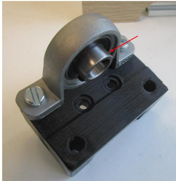
Le mettre à cheval sur le profilé et fixer latéralement avec des vis de M5x16 sans serrer, le support devant pouvoir rester mobile pour ajustement :
