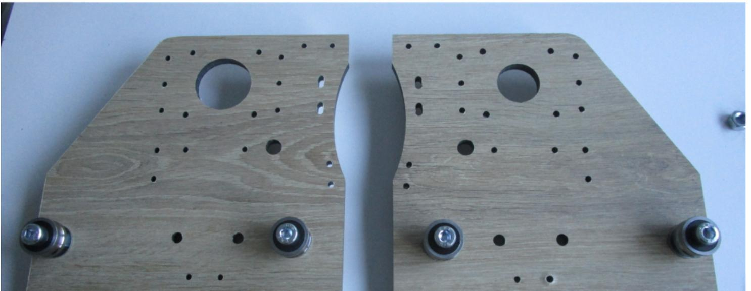
Si on choisit d'utiliser les vis de serrages des roulements du bas, pré-engager les vis M4x20 (à l'avant) et M4x25 (à l'arrière) dans les trous percés précédemment et visser l'écrou sur la vis sans serrer :
