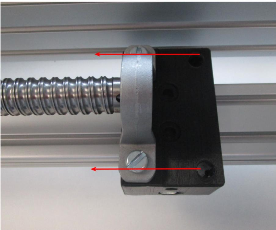
Une fois les différents éléments en place, redévisser les vis d'extrémités, enlever le profilé et serrer les vis latérales internes. Puis remettre le profilé en place et les vis d'extrémité mais sans serrer. [Ou bien, si on a monté la vis à billes le profilé étant sur la tranche, on monte le profilé en vissant les vis d'extrémités, sans serrer ]
