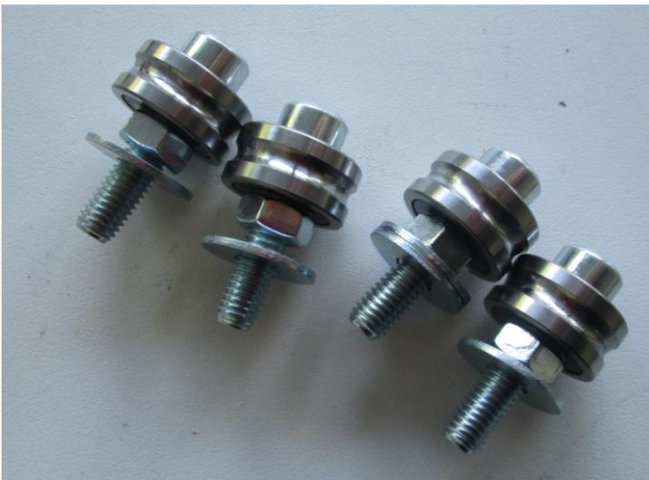
Si on choisit d'utiliser les vis de serrages des roulements du bas, pré-engager les vis M4x20 (à l'avant) et M4x25 (à l'arrière) dans les trous percés précédemment et visser l'écrou sur la vis sans serrer :
