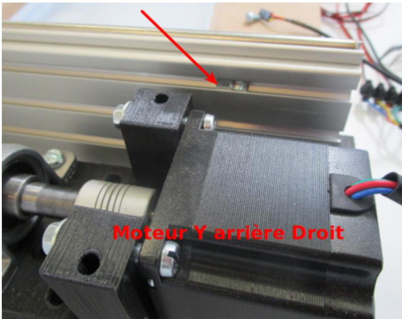
Fixer le endstop sur le support à l'aide des vis M3
