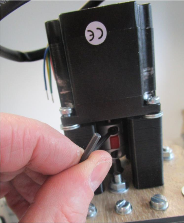
Note : il est important de bien serrer les vis de serrage car l'axe Z doit être parfaitement entraîné...
