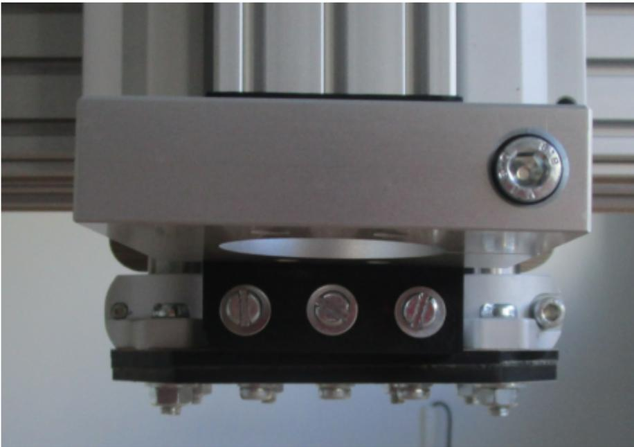
Une fois fait, on peut tester la mise en place de la broche KRESS 1000W par exemple (modèle conseillé et disponible à la commande en option du kit) :
