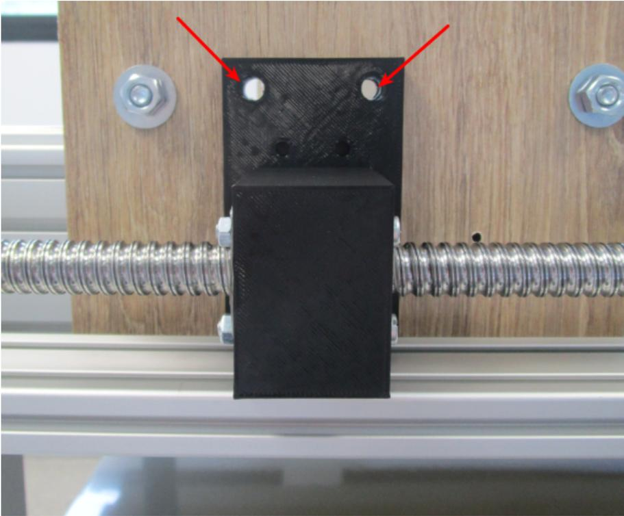
Visser en partie haute avec les vis THC M8 x 25mm + rondelle moyenne + rondelle large + écrou :
