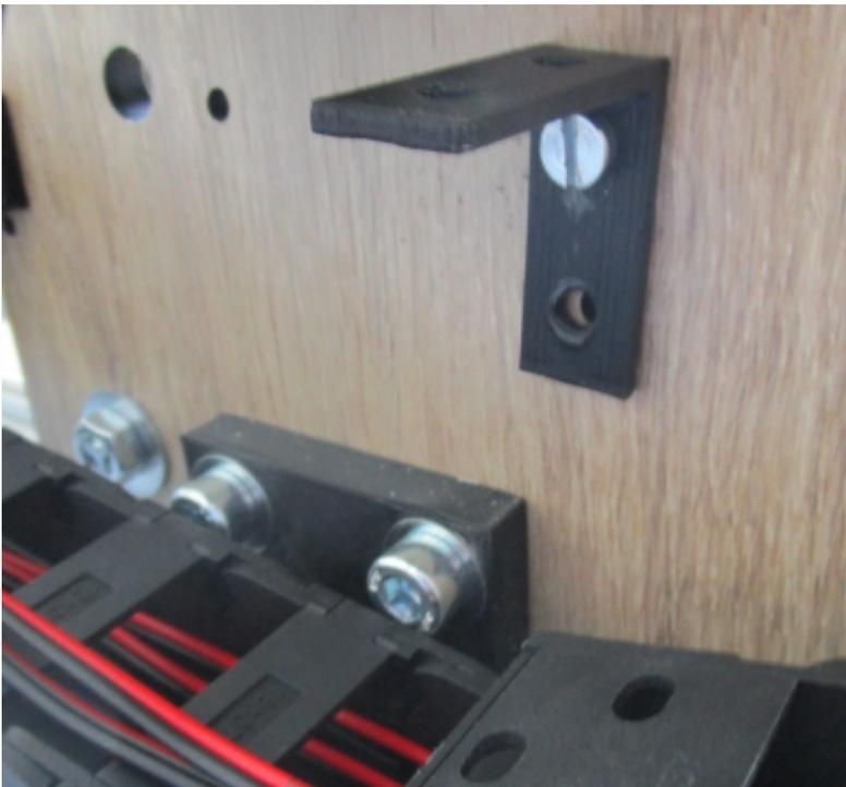
Fixer l'extrémité « moteur » de la chaîne sur l'équerre :
