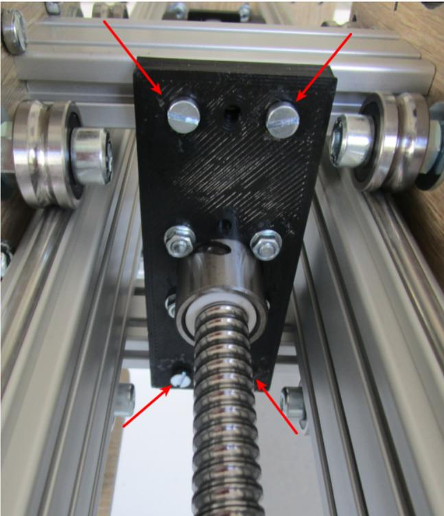
Engager la vis à billes dans les roulements des 2 côtés . Remettre et serrer les vis de serrage :
