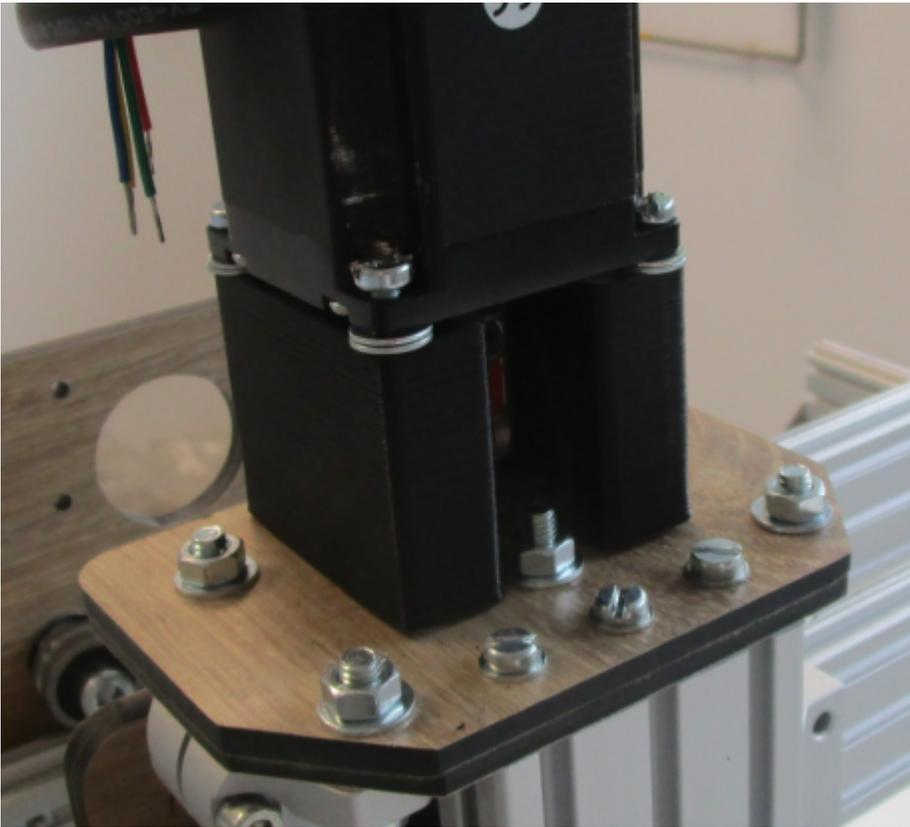
Note : si les vis M5x60 ne « prennent » pas dans la plaque, découper de la tige fileté M5 de 80mm et serrer avec 1 écrou +rondelle de chaque côté ... mais normalement les trous sont prévus pour que les vis auto-tarudent la plaque.
