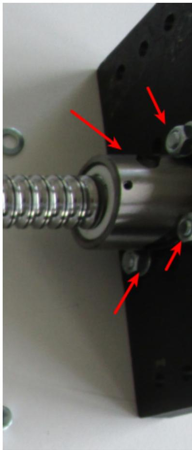
Fixer le moteur Nema 23 avec 4 vis M5 x 20 + rondelle + écrou sans serrer :
