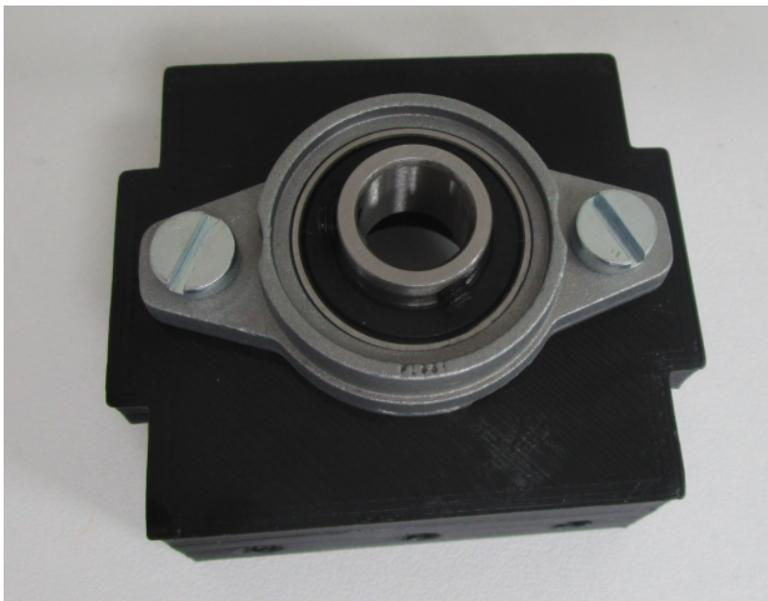
De la même façon, monter le roulement à billes à plat KFL001 (axe 10mm) sur son support vertical à l'aide de 2 vis M6 x 20 (face plate contre face plate ) sans serrer à fond :
