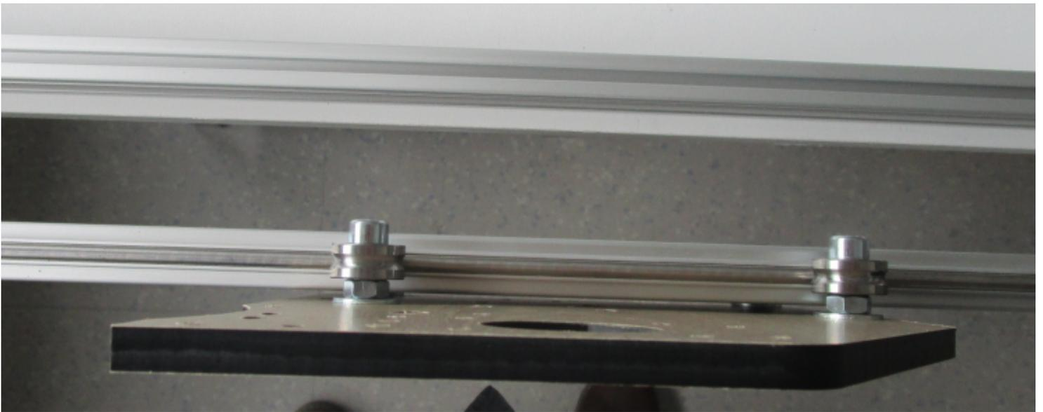
Déplacer le cadre de façon à avoir pleinement accès aux roulements du chariot sous le rail Y.
