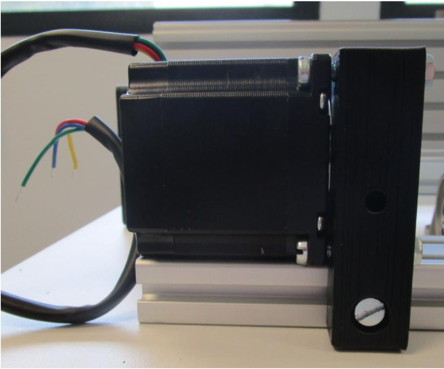
Monter le support de roulement à semelle KP001 sur le support en position « basse » à l'aide de 2 vis M6 x 40mm + écrou M6 et en tournant la partie la plus « protubérante » du roulement vers le moteur :
