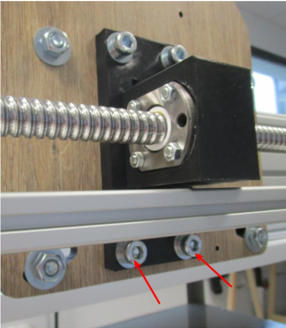
Cette double fixation assure à la fois une rigidité renforcée de la plaque du Y et un entraînement parfait du chariot des Y par l'écrou de la vis à billes.
