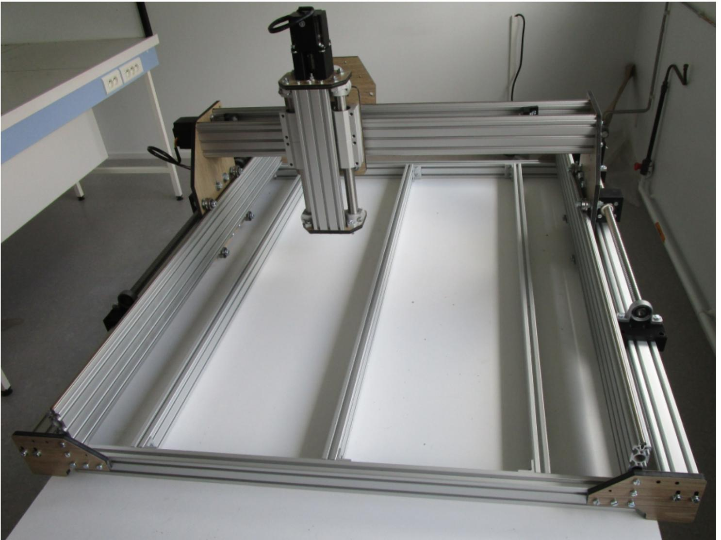
**Mise en place des moteurs et entraînement : version [courroie](#).**
