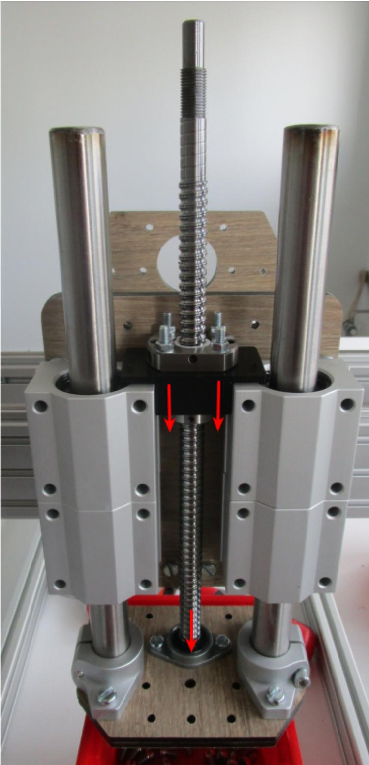
Revisser les 2 vis M6 de fixation des blocs alu enlevées précédemment, qui traversent cette fois le support d'écrou : les trous de la plaque, du support et des blocs alu doivent être alignés.
