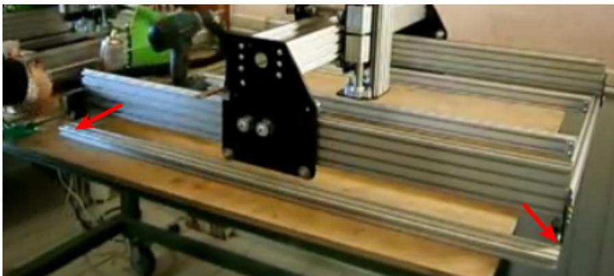
Dans la version à vis à billes, ce profilé sert aussi de support à la vis à billes...
