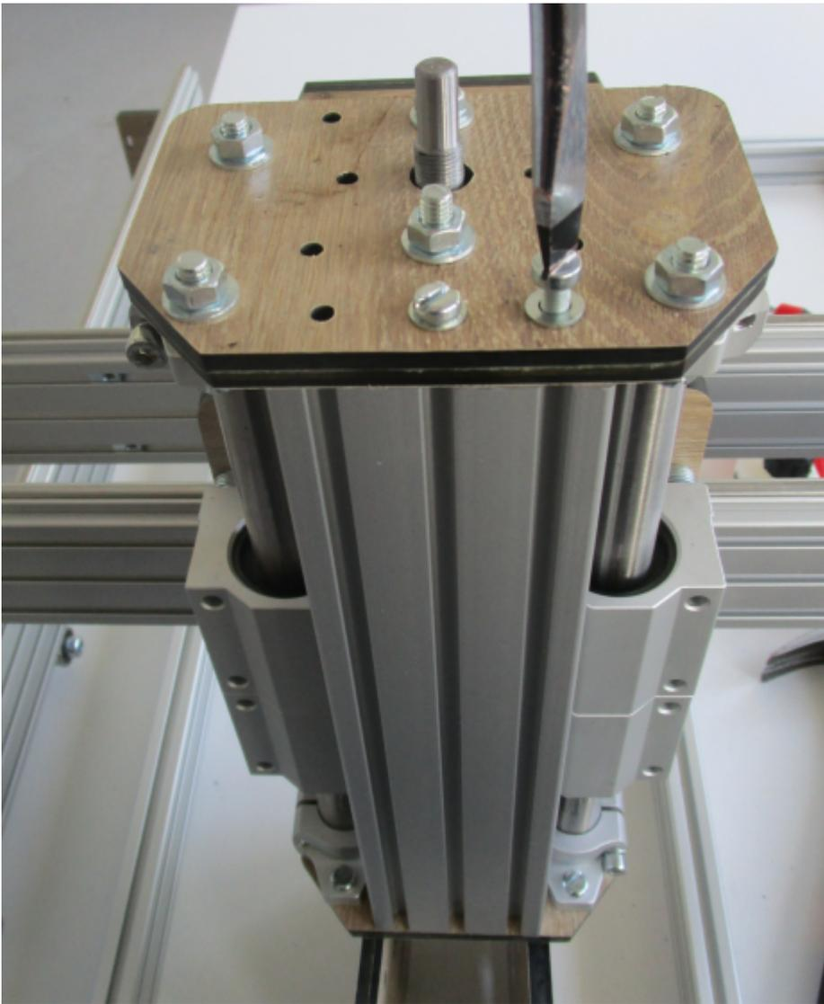
Truc : vérifier que toutes les vis de serrage des supports d'extrémités 20mm sont desserrées et remettre le support rigide sous la plaque du bas et taper au marteau si un écartement résiduel existe : tout doit s'ajuster parfaitement.
