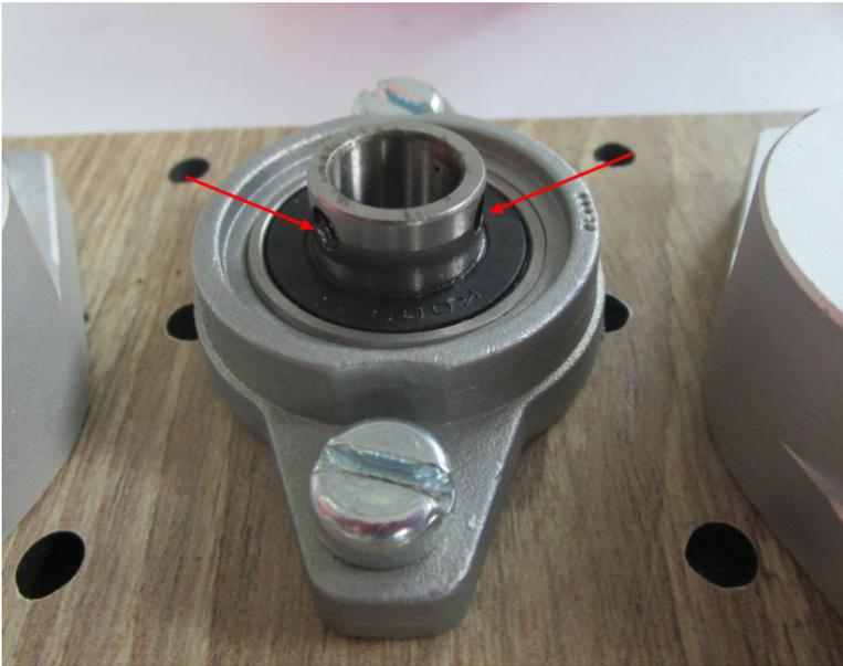
Dévisser au maximum les vis de serrage des supports d'extrémités de barre 20mm et engager la plaque supérieure :
