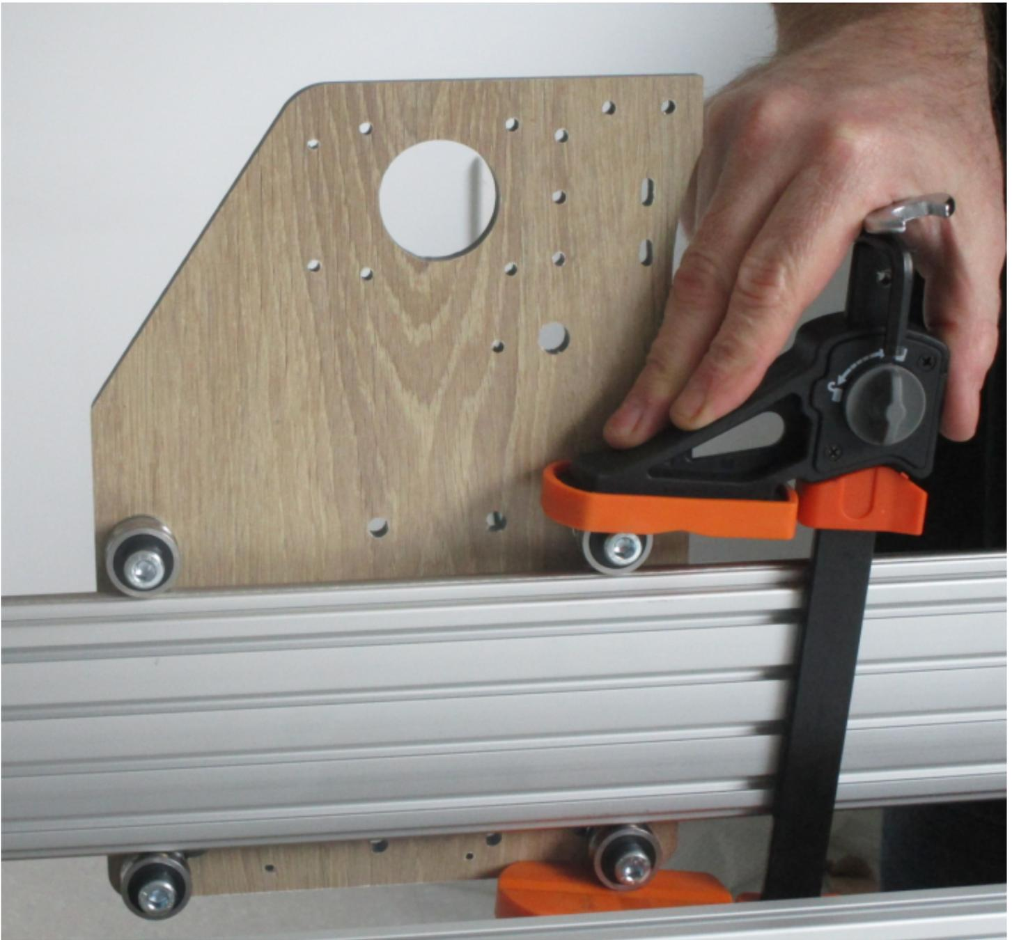
Puis serrer les vis extérieures avec une clé plate. Faire de même pour les 2 autres roulements puis vérifier la bonne translation du chariot sur le rail Y :
