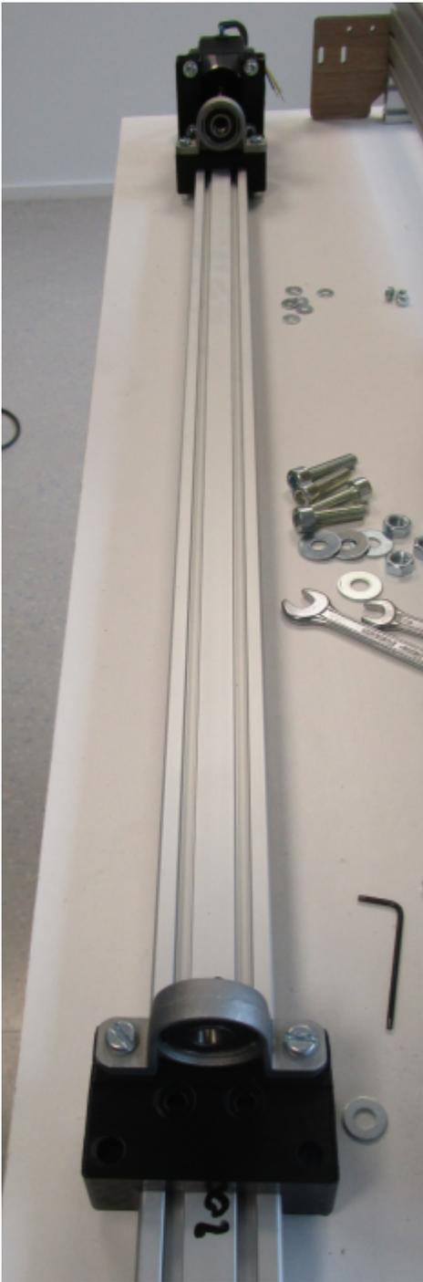
Mettre en place le coupleur d'axe à mâchoires sur l'axe du moteur :
