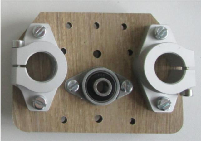
NOTE +++ : Il est essentiel de faire en sorte que le minimum de longueur dépasse de la plaque inférieure du Z (sinon risque d'accrochage dans fixations plaque, etc. en pleine découpe et blocage/casse de fraise). Par conséquent, **mettre les têtes de vis en bas sur la plaque inférieure** (pas comme sur la photo donc...), voire même réaliser une empreinte pour les têtes de vis au foret bois de 10mm
