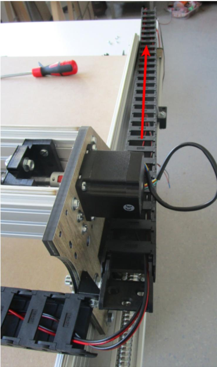
Engager également les 2 câbles de 2m en mettant la barrette de connexion du même côté que l'entrée des câbles arrière (côté moteur X) :
