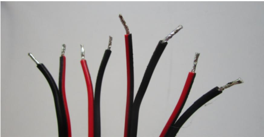
Mettre les barrettes de connexion sur l'une des extrémités des câbles (mettre les 2 câbles de 2m sur la même barrette, les 2 câbles de 0,5m sur la même barrette et les 2 câbles de 3m sur la même barrette) en mettant le rouge du côté droit et le noir au gauche à chaque fois. Cette extrémité sera l'extrémité « moteur ».
