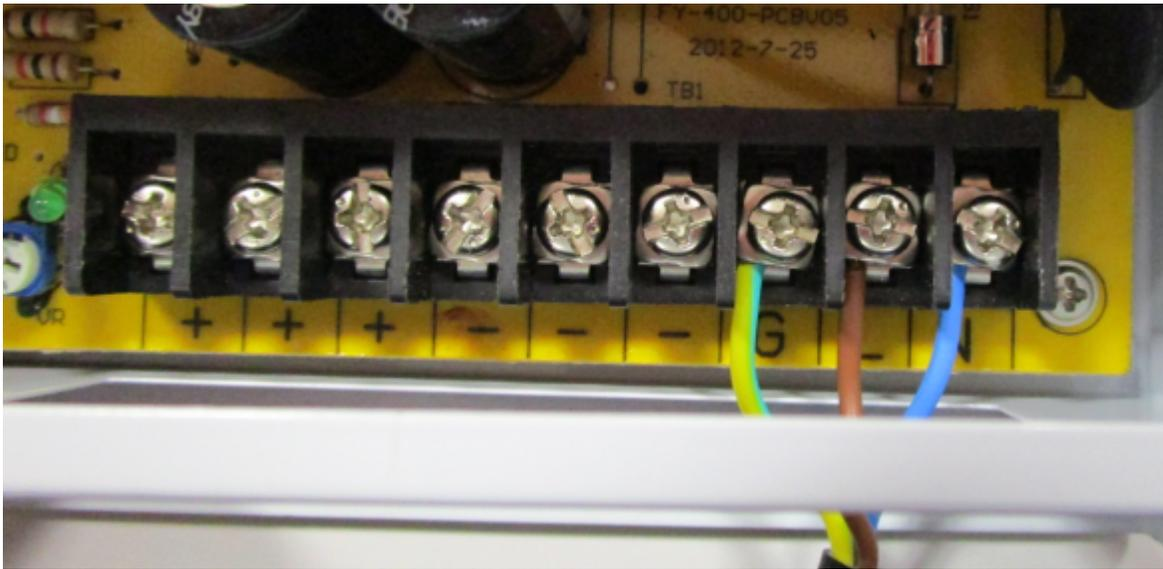
Connecter une extrémité du câble 12V à 2 brins sur l'alimentation en veillant à connecter le (+) sur le câble rouge et le (-) sur le câble noir :
