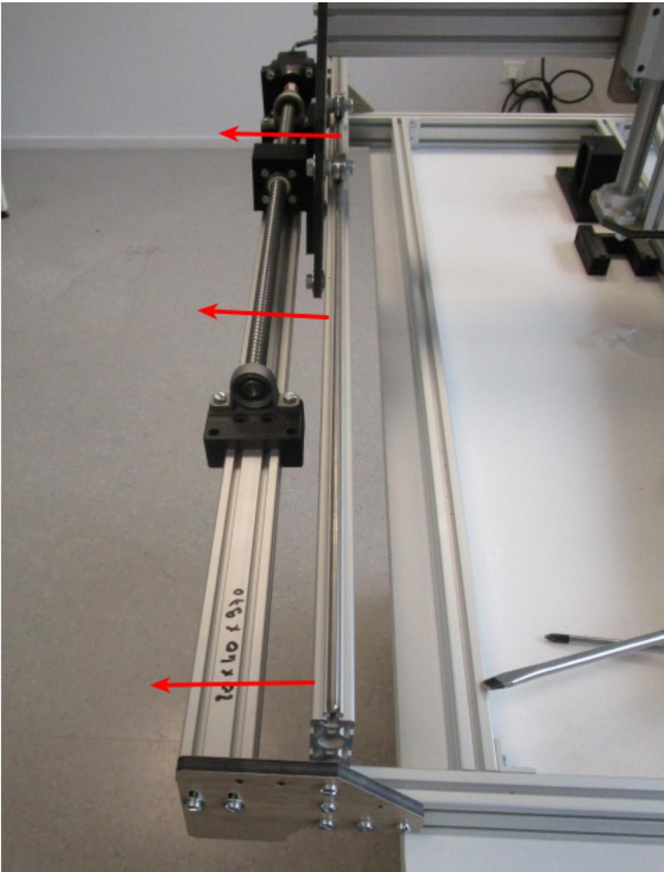
Venir placer (par rotation de la vis à billes) les trous de la plaque du support d'écrou en regard des trous de la
