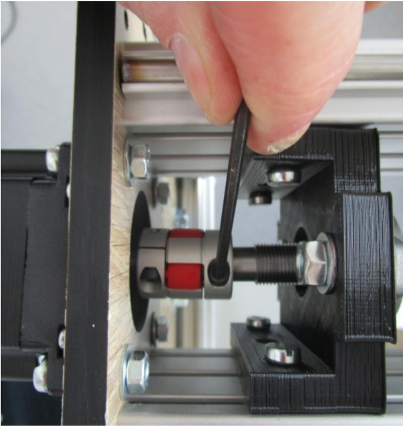
Une fois que tout est en place : serrer les vis de fixation des supports verticaux, des roulements, etc.
