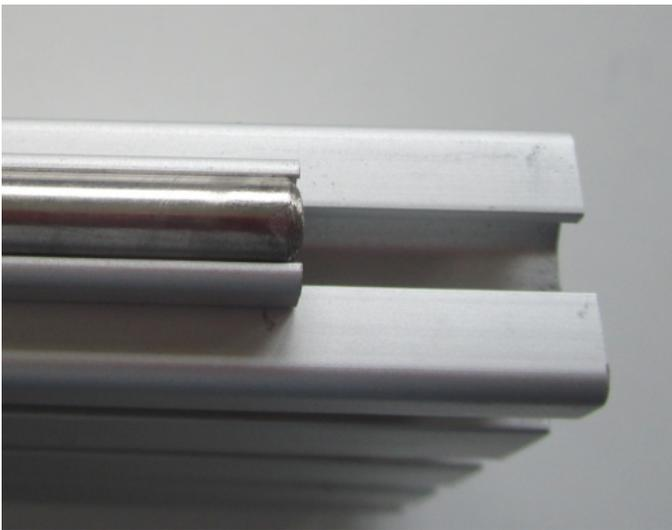
La barre lisse 6mm x **930** sur le **dessous** et la barre lisse 6mmX**970** sur le **dessus** pour chaque rail Y.
