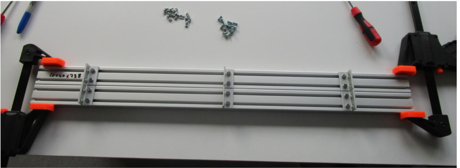
Truc : on pourra s'aider un profilé pour aligner exactement les 2 équerres en vis à vis de chacun des profilés :
