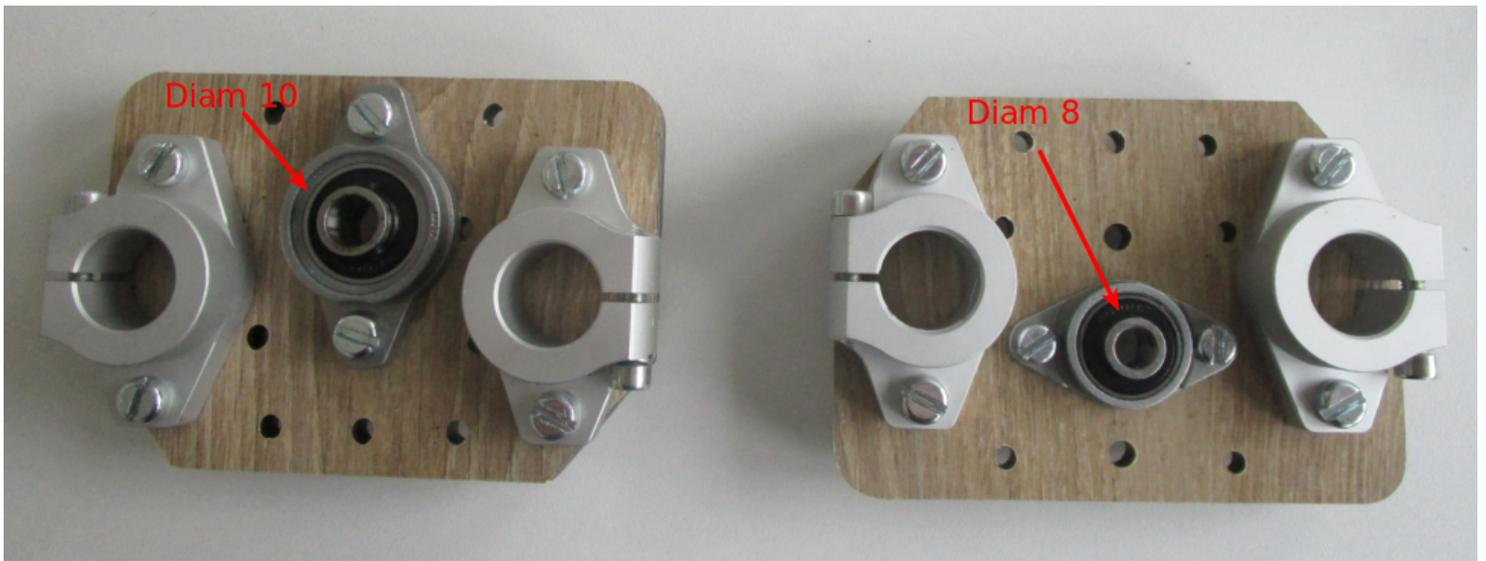
Note : veillez à mettre les vis de serrage des supports d'extrémités vers l'extérieur.
