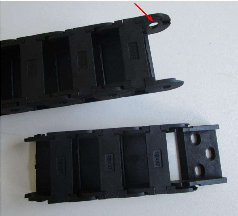
**XL :** Enlever 10 chaînons de la 3ème chaîne et les clipser sur l'une des 2 autres chaînes ce qui porte la chaîne à 1,3m environ. Faire 2 même pour la seconde chaîne. Il doit rester une 10aine de chaînons en rab' qui pourront servir au besoin.
