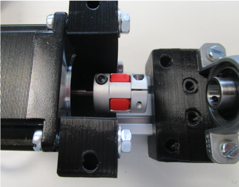
Enlever les vis de serrage de l'axe des roulements à billes :
