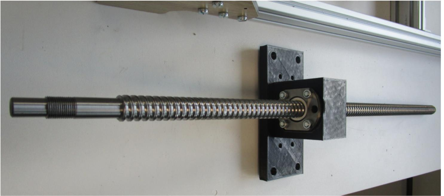
Monter le support de roulement à semelle KP000 sur le support en position «haute » à l'aide de 2 vis M6 x 40mm + écrou M6 et en tournant la partie la plus « protubérante » du roulement vers la vis à billes :
