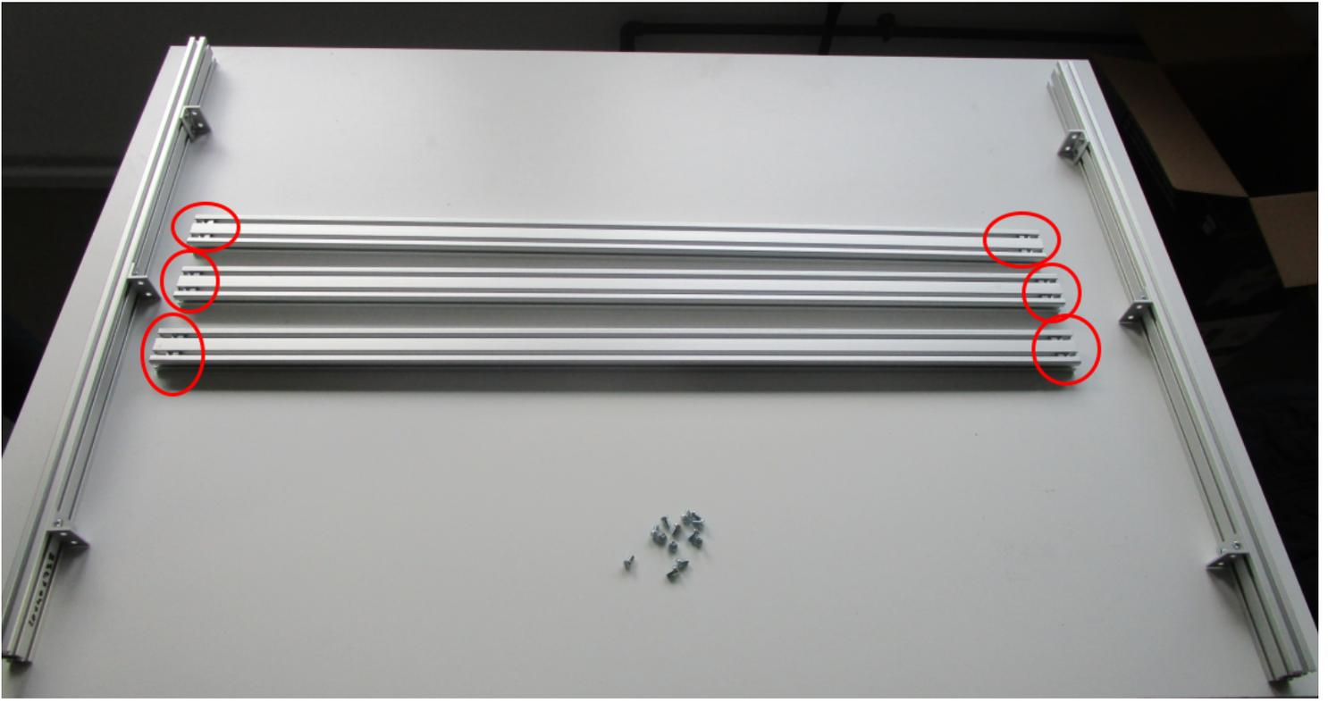
Ensuite, mettre en place le cadre en plaçant les profilés avant et arrière perpendiculairement au 3 profilés **20x40x930** en regard des équerres (veiller à mettre les équerres du milieu du même côté du profilé interne) et fixer les profilés entre eux :
