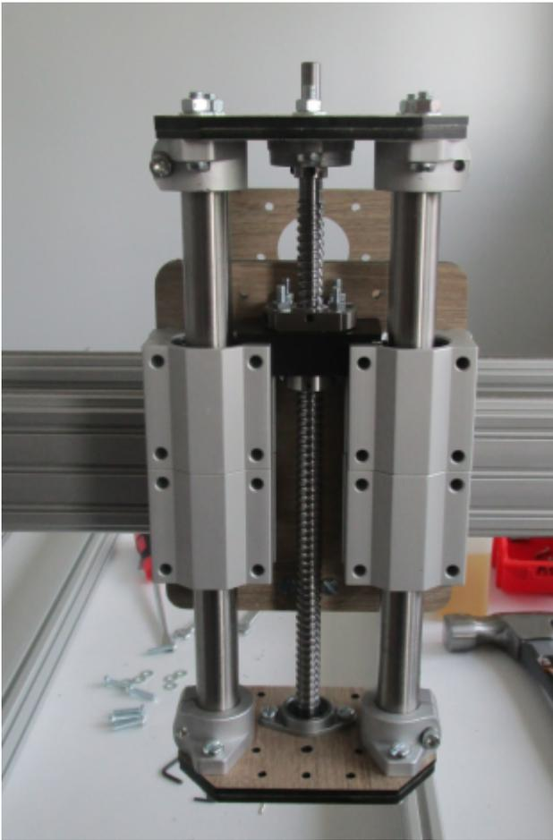
On peut pré-engager et mettre en place 3 x 2 écrous lourds dans les 3 rainures de la face avant du profilé [20x60x270](#) du Z :
