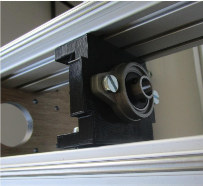
Enlever les vis de serrage de roulements :
