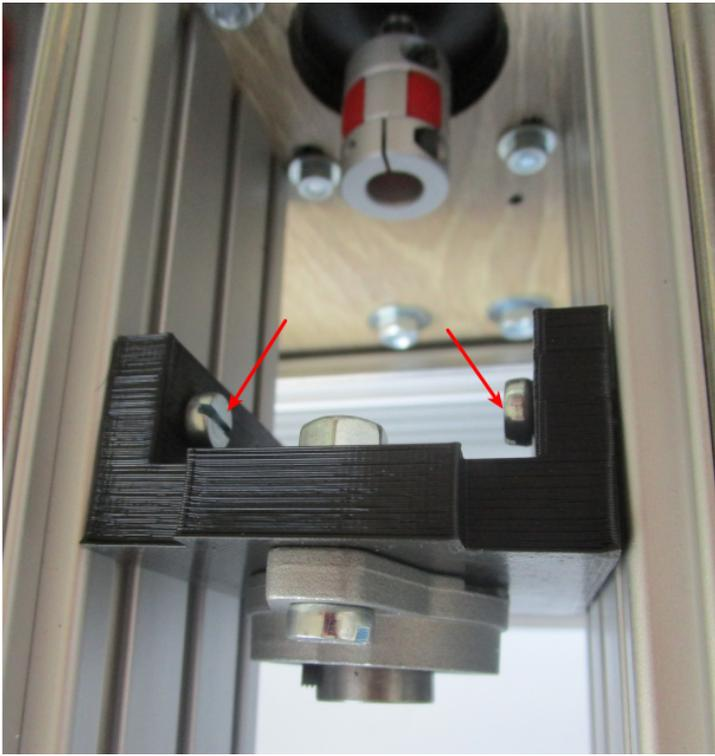
**NOTE : si les écrous lourds ne sont pas pré-engagés, il est facile de l'insérer sur la tranche puis de le faire basculer dans la rainure à l'aide d'une clé allen.**
