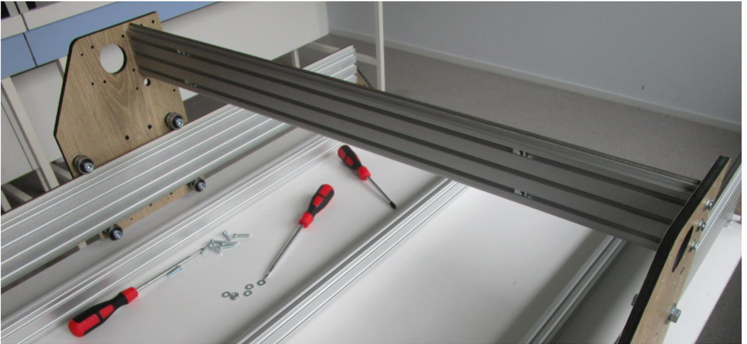
Ensuite, monter le 2ème rail X sur la même plaque de chariot X avec une seule vis et prépositionner également avec une vis sur le chariot Y en vis à vis :
