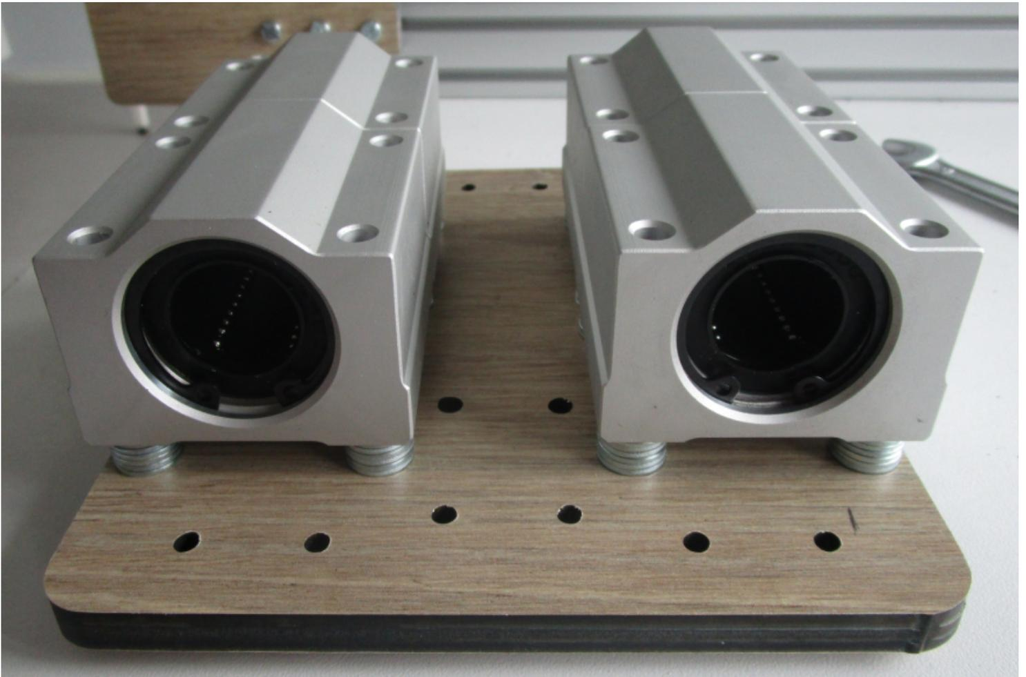
Truc : pour tenir les rondelles en place, on pourra visser transitoirement un écrou M6 sur la vis M6
