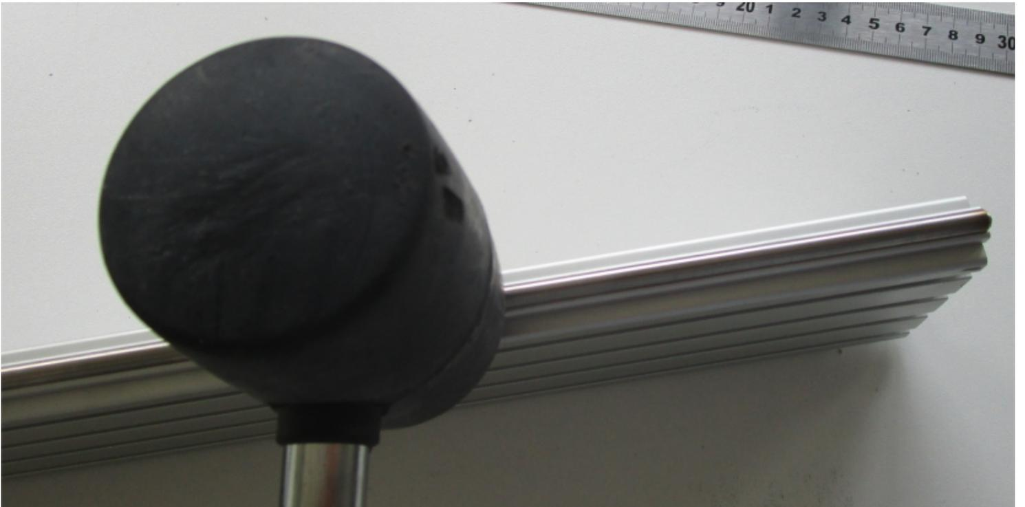
Une fois fait, la barre lisse doit être parfaitement clipsée sur toute sa longueur dans le clip aluminium lui-même engage dans la rainure du profilé :
