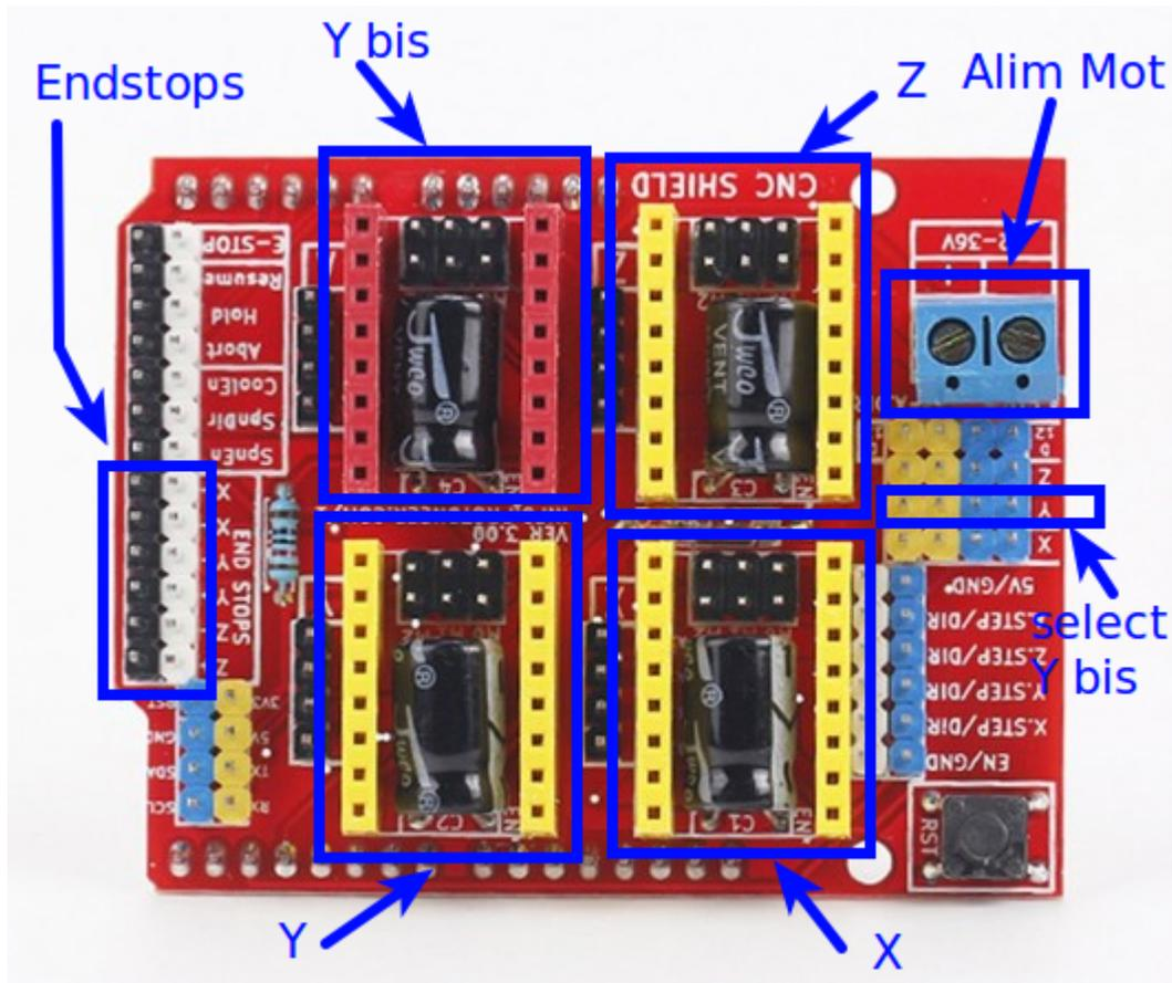
Ici, le CNC-shield n'est utilisé qu'à des fins de connectique de la logique de commande (en clair, on va utiliser le CNC-shield pour mettre facilement en connexion les étages moteurs et les broches de la carte Arduino ). Toute la partie de puissance n'est pas utilisée ici : ce sont les étages de puissance séparés qui feront le job.
