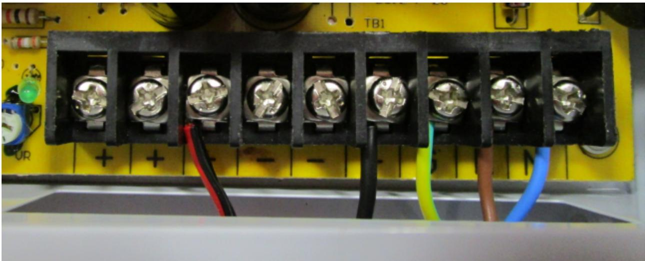
Connecter l'autre extrémité de chaque câble 12V à 2 brins sur le bornier alimentation moteur de chaque étage moteur : bien dévisser les vis du borniers pour pouvoir engager les câbles étamés.
