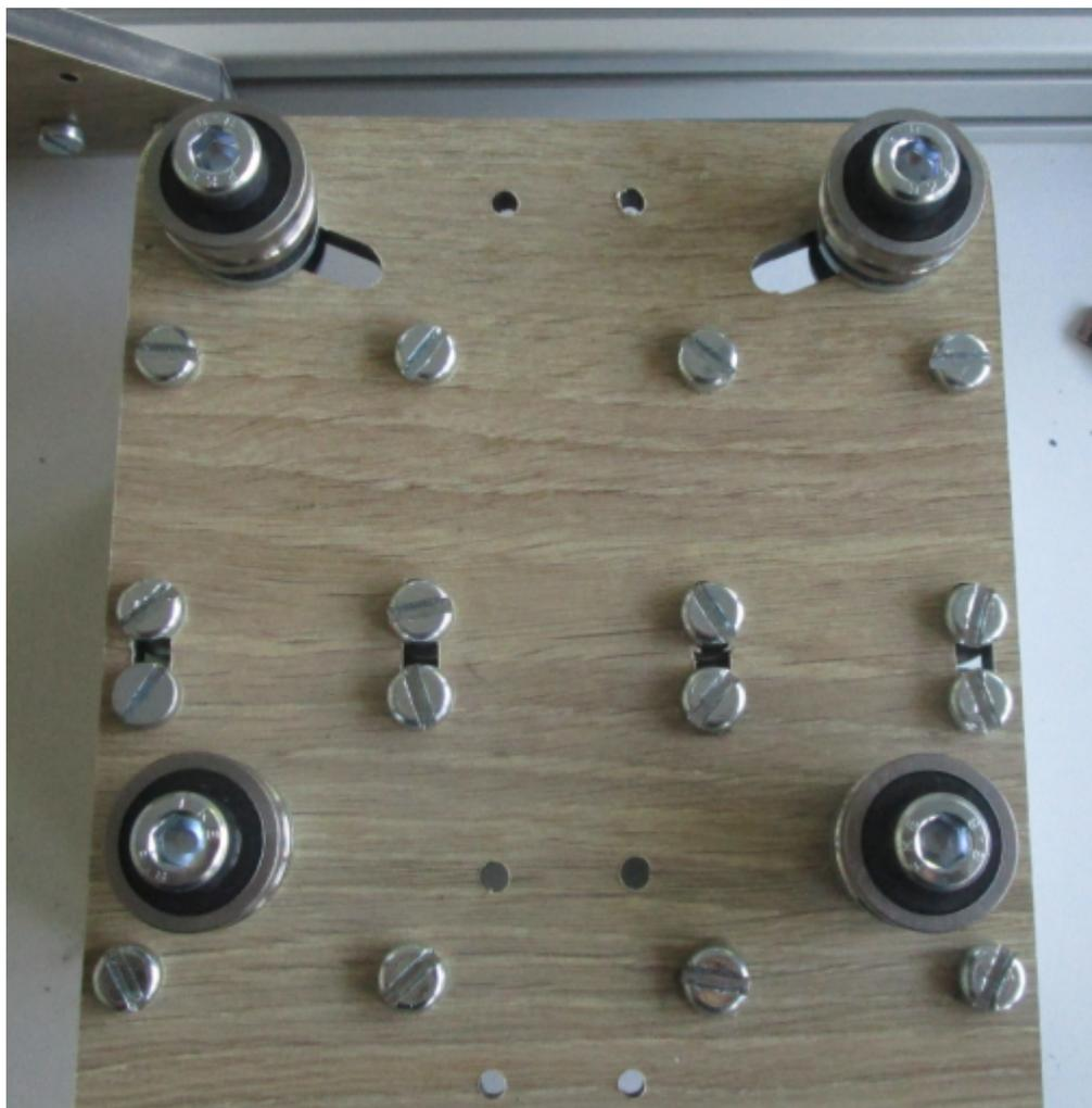
Ensuite, sur la plaque arrière du chariot des X, on vient fixer les 2 roulements du haut avec 2 vis M8x35 + écrou + rondelle M8 moyenne + plaque + rondelle M8 moyenne + écrou :
