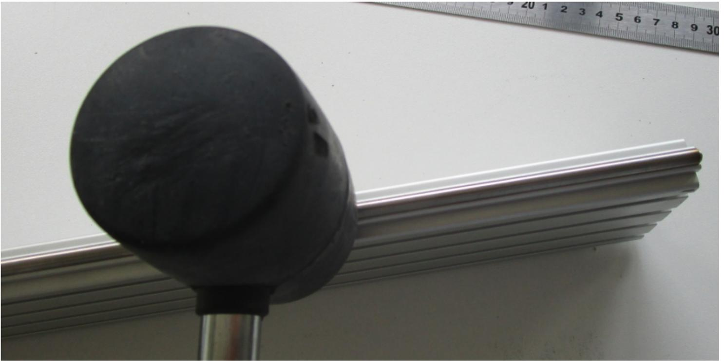
Une fois fait, la barre lisse doit être parfaitement clipsée sur toute sa longueur dans le clip aluminium lui-même engagé dans la rainure du profilé :
