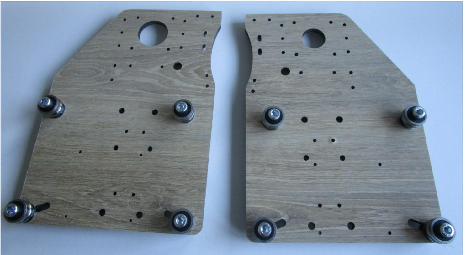
Bien veiller à inverser les faces de montage des roulements sur les 2 chariots, l'un étant le gauche et l'autre le droit.
