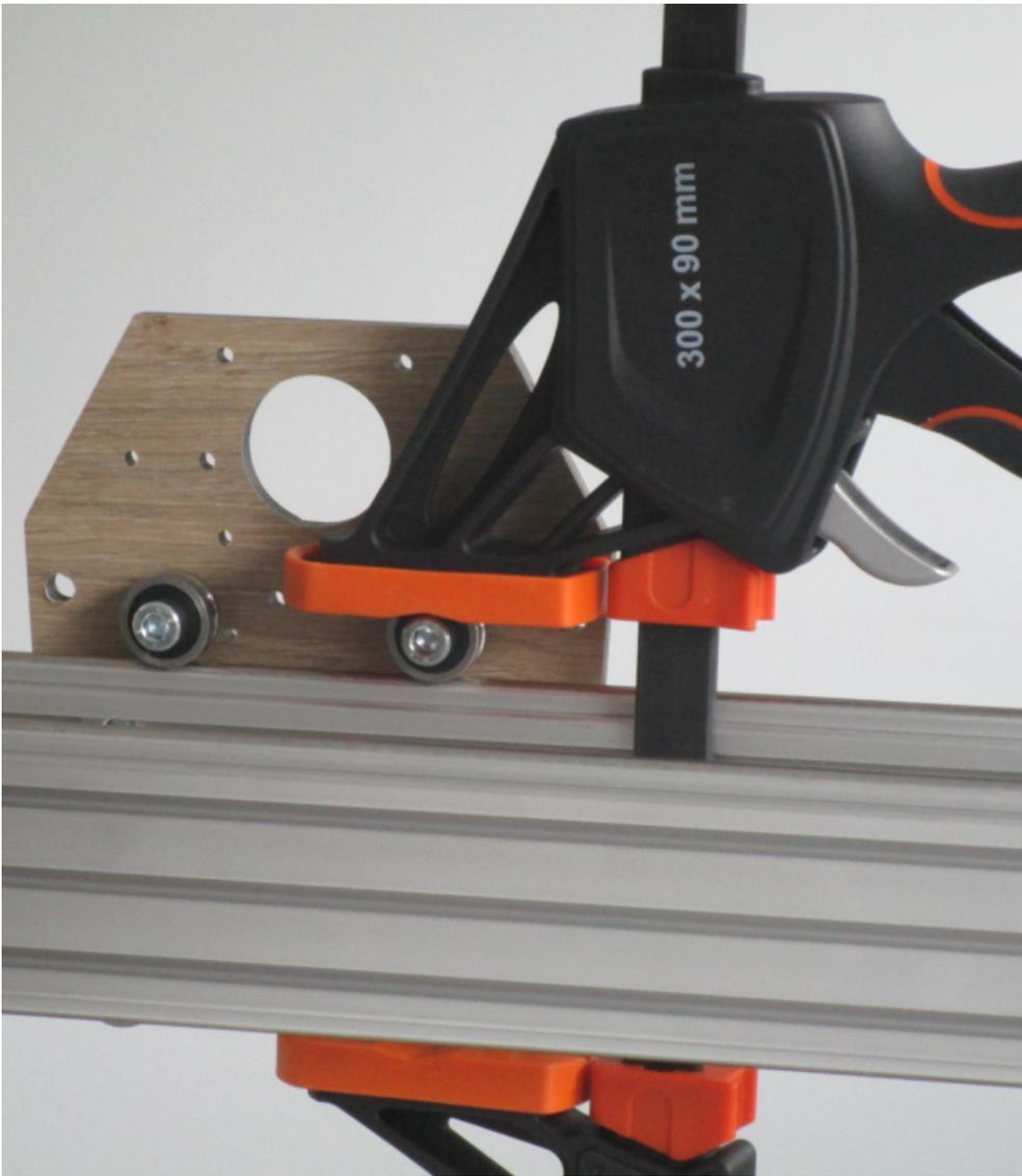
Truc : regarder dans les trous des plaques du chariot Y pour vérifier le bon alignement / engagement des roulements en U sur les barres lisses de guidage :
