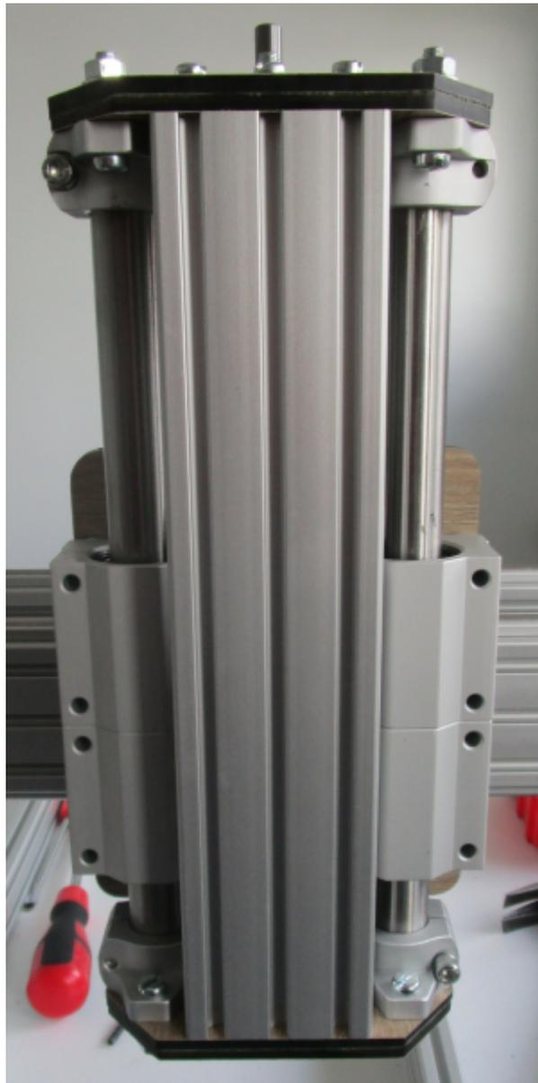
Note : la rotation de la vis à billes doit être fluide. Au besoin, desserrer un peu les vis de fixation des roulements de la vis à billes , laisser la vis à billes se réaxer puis resserrer.
