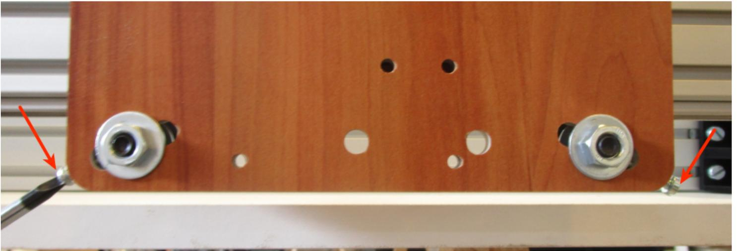
Une fois les vis de serrage serrée (on doit obtenir une translation fluide avec une légère contrainte), serrer les écrous des vis de fixation des roulements eux-mêmes.
