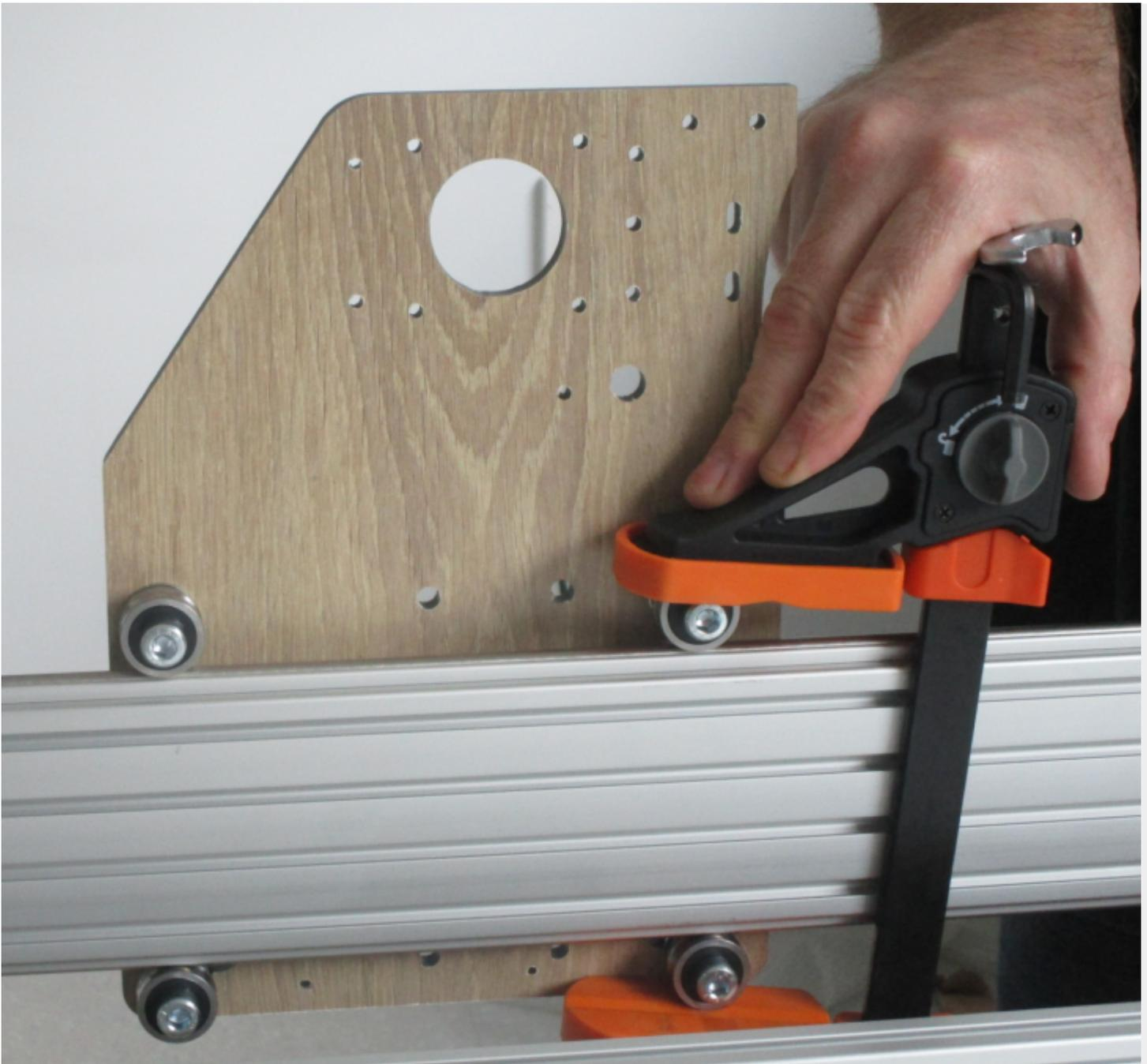
Puis serrer les vis extérieures avec une clé plate. Faire de même pour les 2 autres roulements puis vérifier la bonne translation du chariot sur le rail Y :
