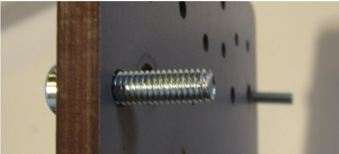
Monter les 4 blocs de douilles à billes 20mm sur la face avant de la plaque avant du chariot des X à l'aide de vis M6 x 25mm en intercalant 6 rondelles entre la plaque et le bloc d'aluminium (important : ne pas mettre de rondelle du côté de la tête de vis) :
