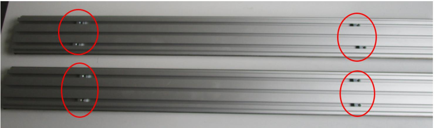
Monter le premier profil à l'aide de 3 vis verticalement sur la plaque de chariot X avec vis M5x20+rondelle :
