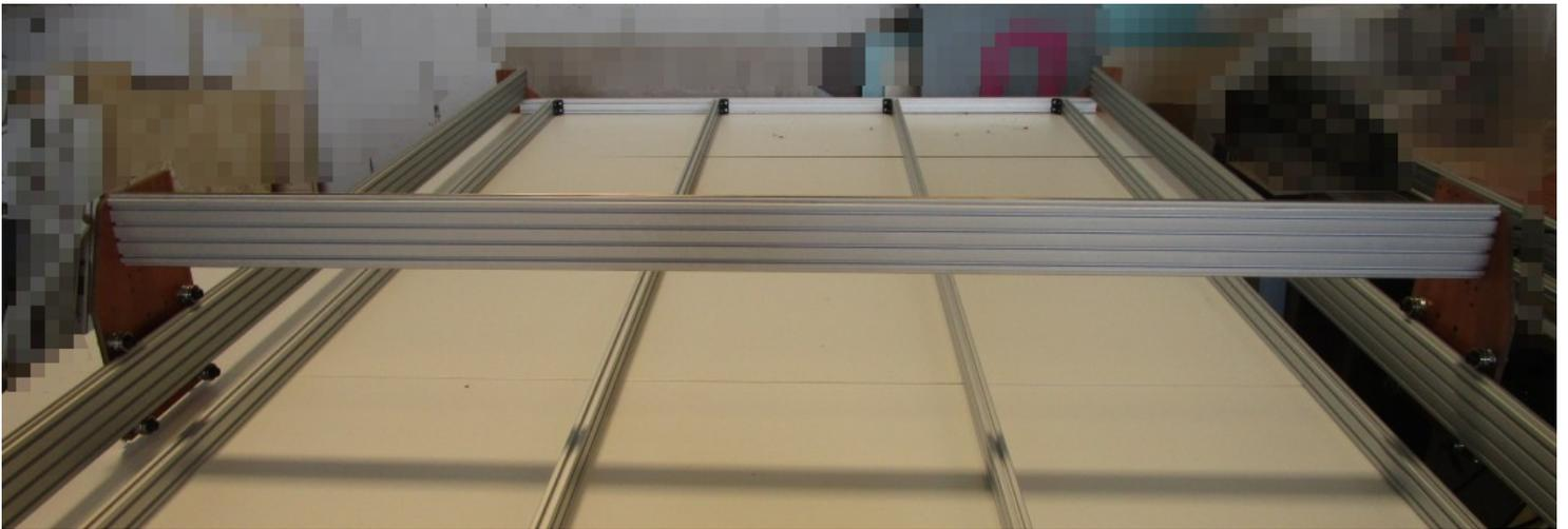
Ensuite, monter le 2ème rail X sur la même plaque de chariot X avec une seule vis et prépositionner également avec une vis sur le chariot Y en vis à vis :
