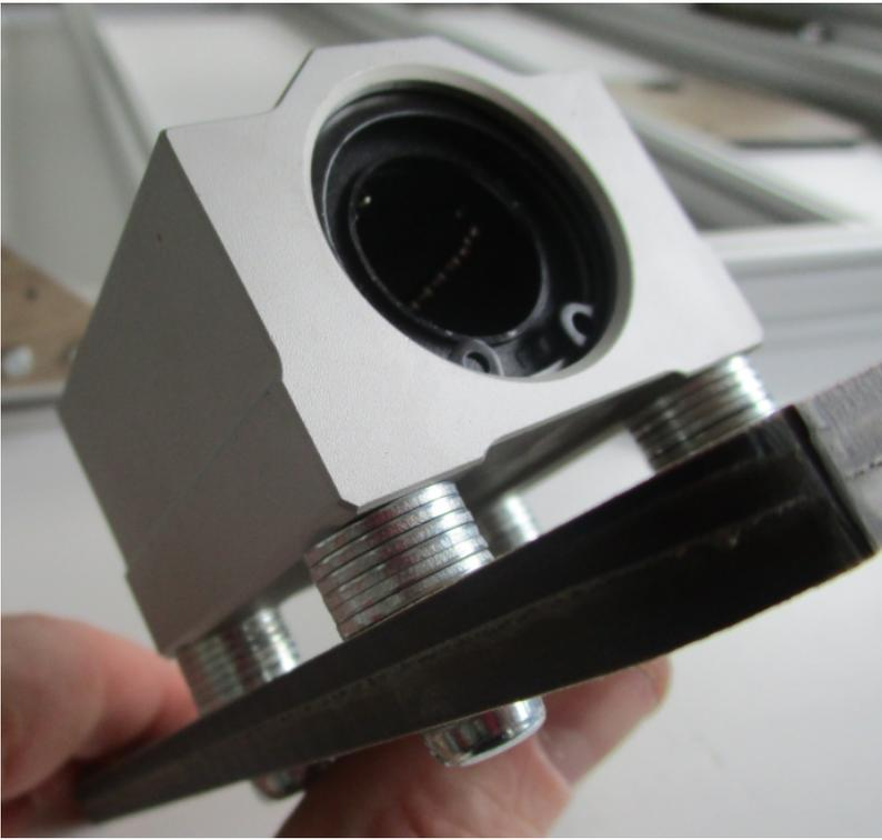
**Il faut serrer les vis et moduler le vissage des vis de façon à ce que les arêtes des blocs aluminium soient parfaitement alignés.**
