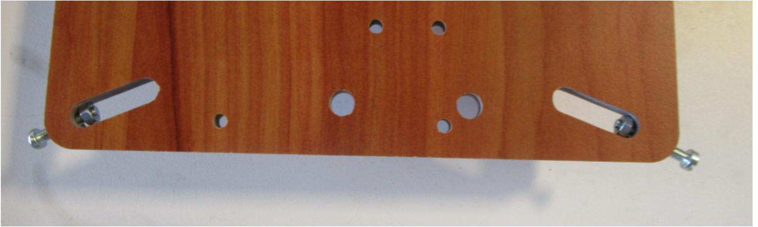
Fixer les roulements du bas avec vis M8 x 35 + écrou + rondelle M8 grande + rondelle M8 grande + écrou :
