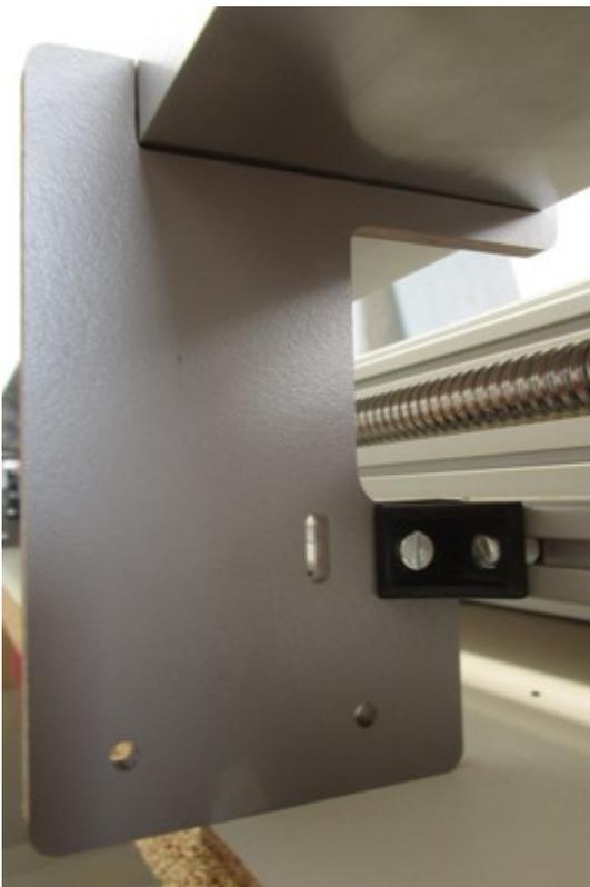
Fixer les 2 supports de « règle à maçon » sur les face interne des chariots de X à l'aide de vis M5x20 + écrous :
