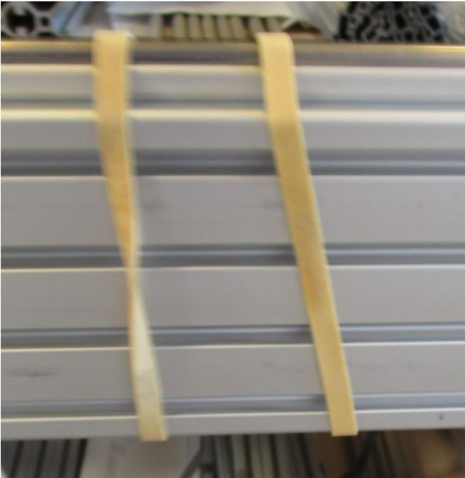
TRUC2 : Ne pas hésiter à utiliser des tréteaux pour poser le profilé avant/après le point de « frappe » sur l'établi. Idéalement, être 2 pour cette manip' est utile.
