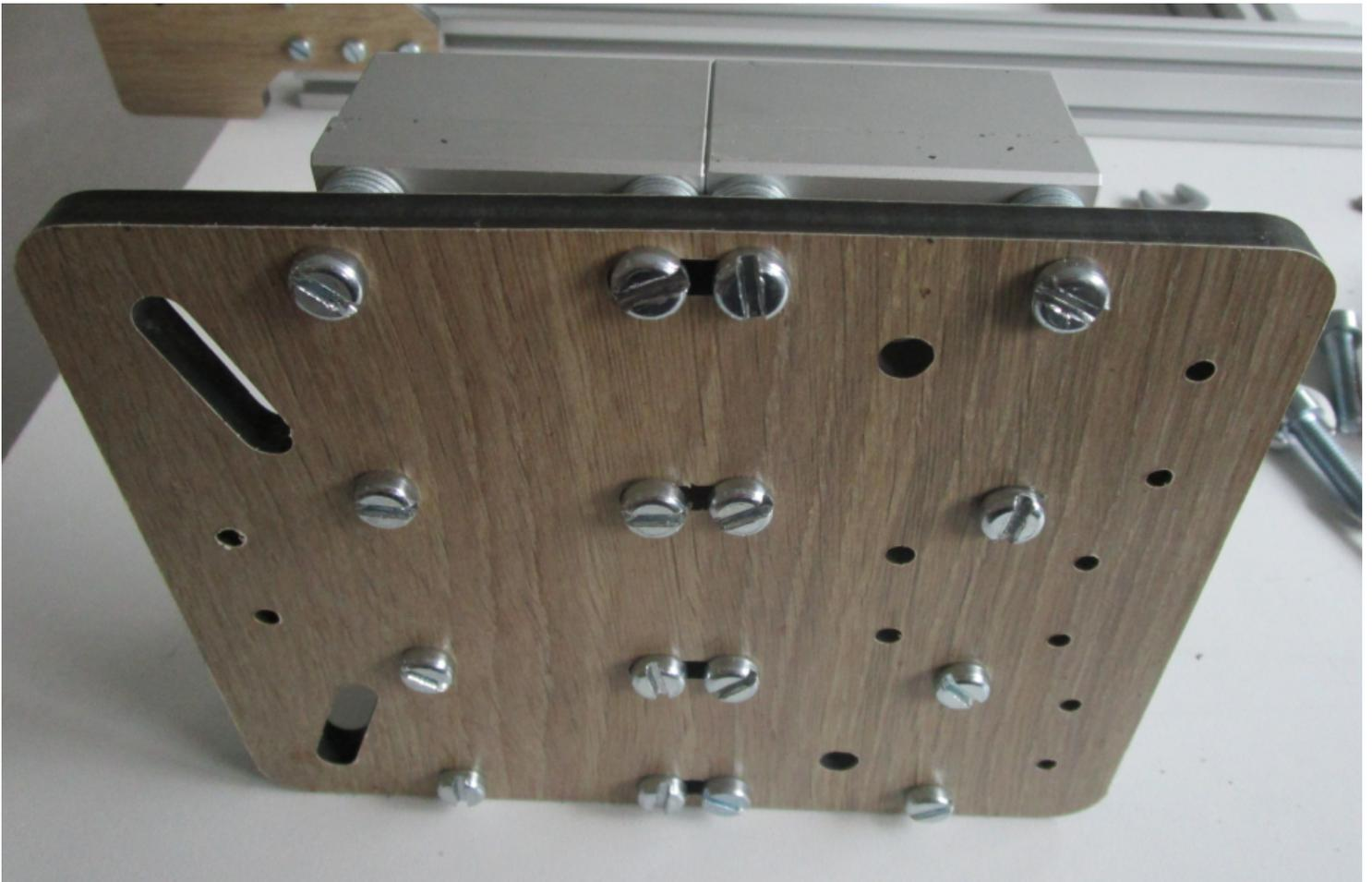
Note : les 2 vis internes seront à redévisser ultérieurement pour mettre en place l'écrou de tige filetée d'entraînement du Z.
